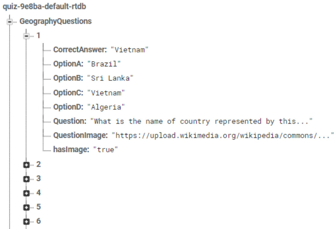
Slika 3.25. Prikaz strukture jednog pitanja u bazi podataka
