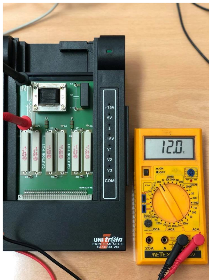
Slika 4.15. Proces određivanja otpornosti prigušnice R
