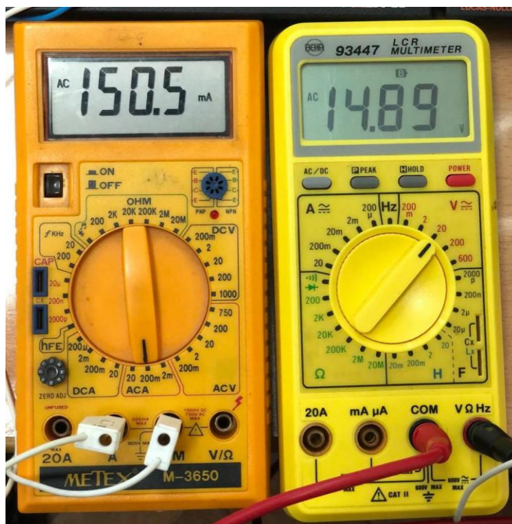
Slika 4.25. Izmjerene efektivne vrijednosti struje (lijevo) i napona (desno) prigušnice
