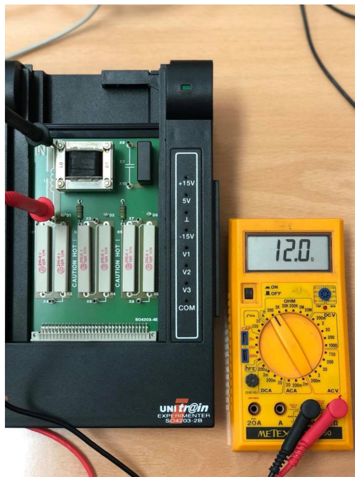
Slika 4.15. Proces određivanja otpornosti prigušnice R
