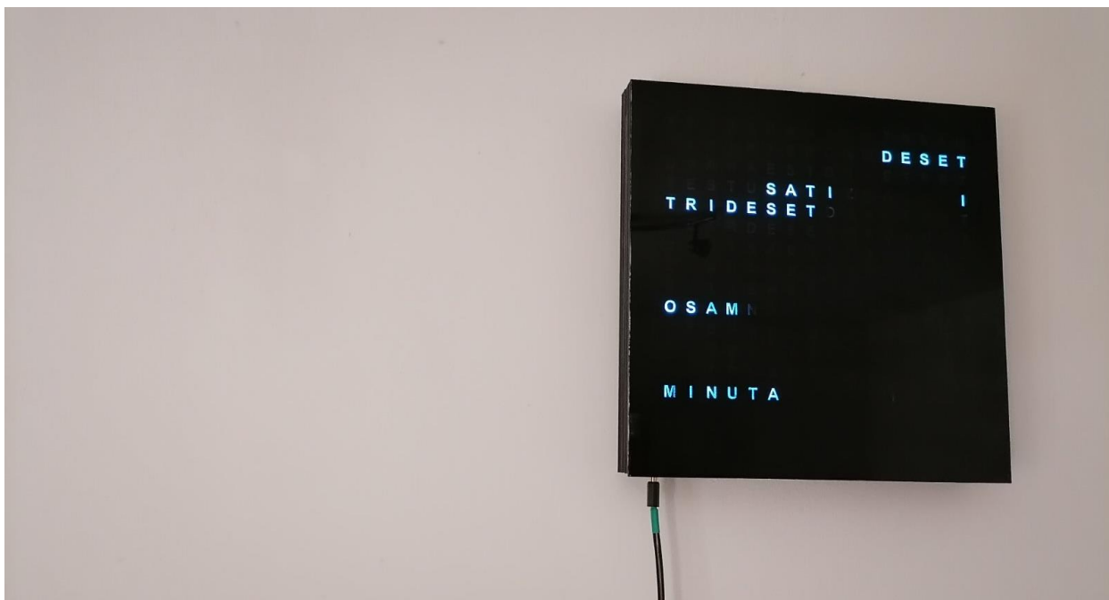
Slika 4.8. Završen zidni sat s riječima s prikazom vremena u svijetlo plavoj boji.
