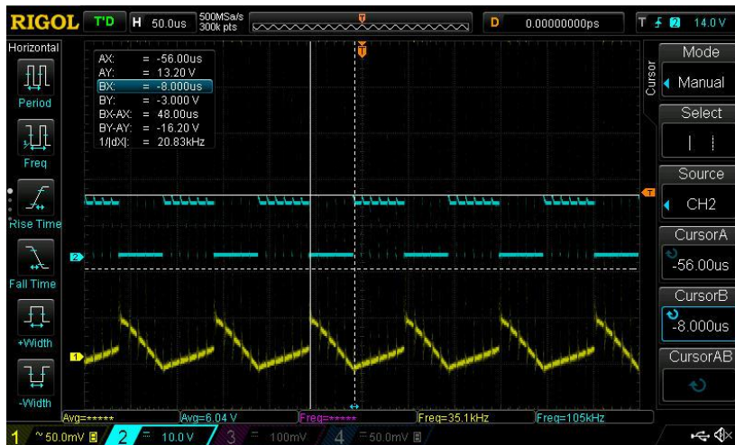
Slika 4.11. Valni oblik upravljačkog signala i napona na izlaznom kondenzatoru
