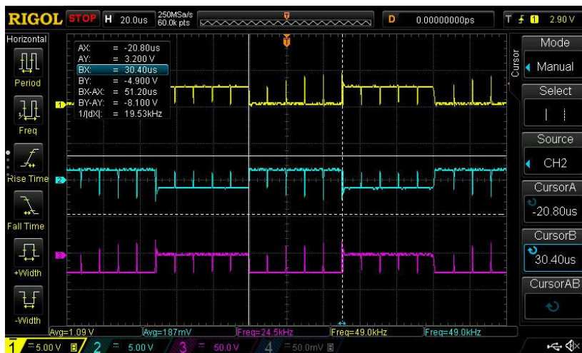
Slika 4.10. Valni oblici napona u_{T1} , u_{D1} i u_L
