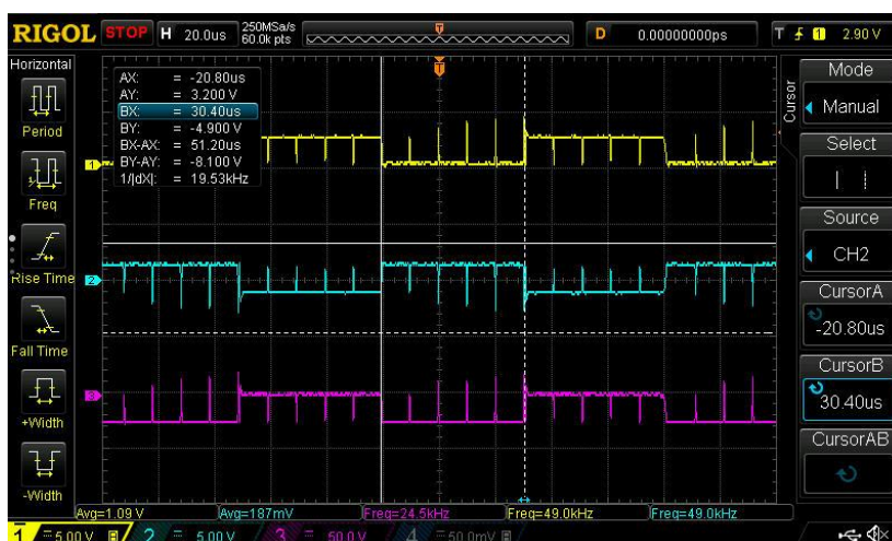
Slika 4.10. Valni oblici napona u_{T1} , u_{D1} i u_L
