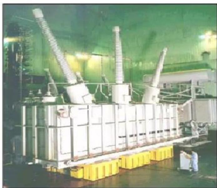
*Slika 3.9. Trofazni autotransformator 500MVA, 512/242/25,2 kV [10].*
