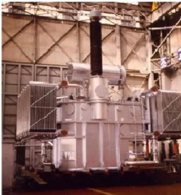
Slika 3.7. Jednofazni autotransformator 83,3 MVA 400/138,6/11 kV [10].
