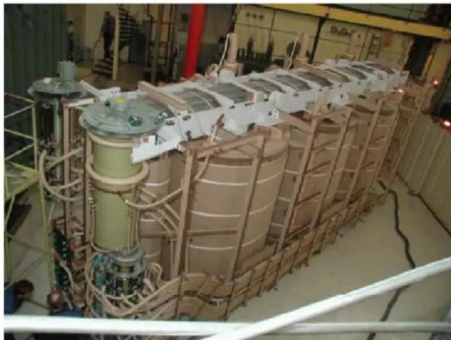
*Slika 3.6. Trofazni autotransformator 400MVA, 400/231/10,5 kV [10].*
