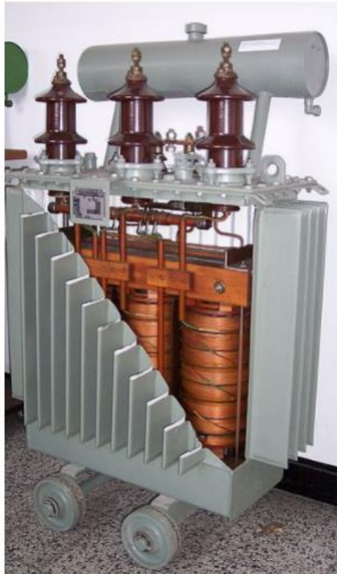
Slika 3.1. Distributivni transformator 630 kVA[6].
