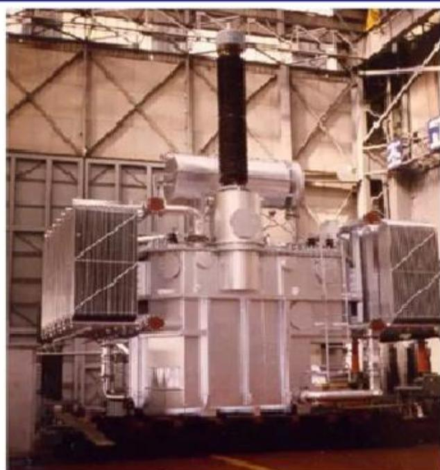
Slika 3.7. Jednofazni autotransformator 83,3 MVA 400/138,6/11 kV [10].
