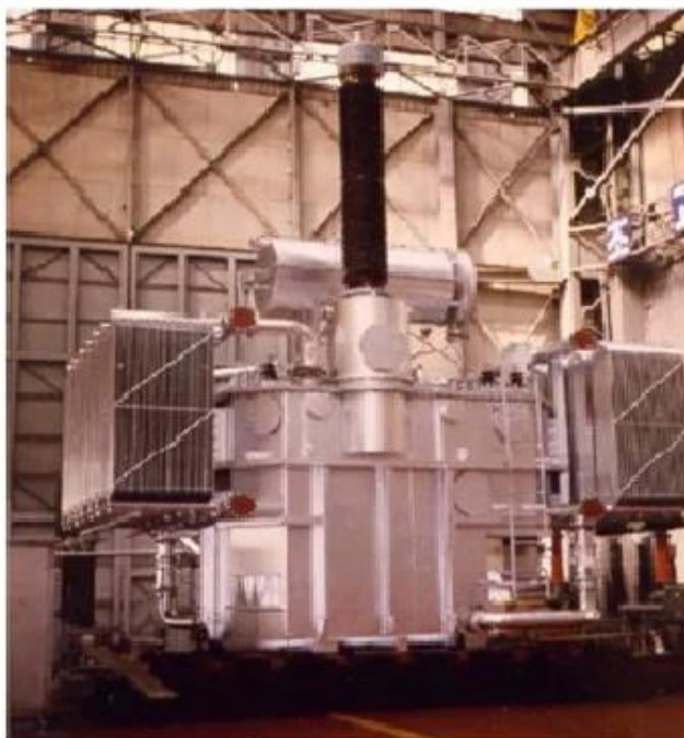
Slika 3.7. Jednofazni autotransformator 83,3 MVA 400/138,6/11 kV [10].
