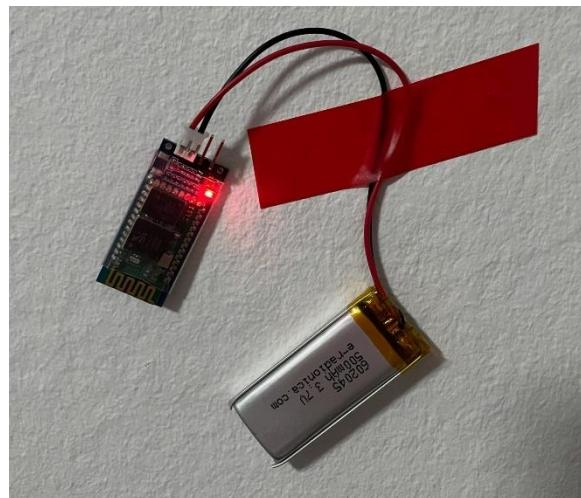
Sl. 3.5. Bluetooth modul HC-06 spojen na napajanje
