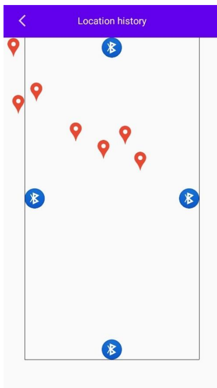
Sl. 4.19. Prikaz rezultata mjerenja za osmu unaprijed određenu lokaciju na zaslonu pametnog telefona
