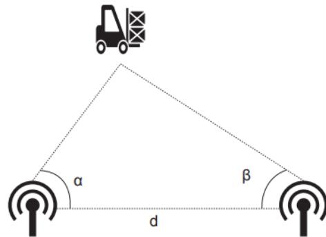
**Sl. 2.1.** Princip određivanja lokacije metodom triangulacije [6]
