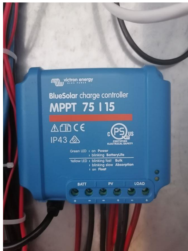
Slika 4-3 BlueSolar regulator punjenja MPPT 75 | 15
