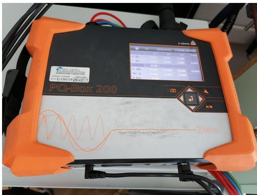
Slika 4-13 Mrežni analizator PQ-Box 200
