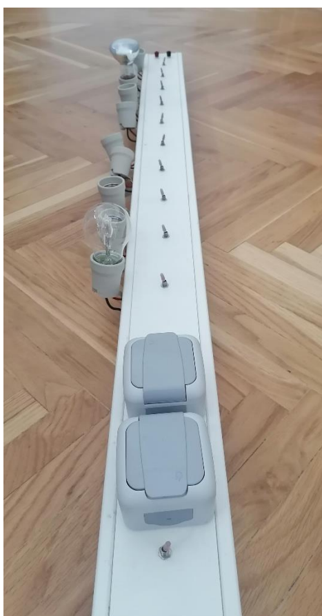
Slika 4-12 Letva s žaruljama kao AC trošilo
