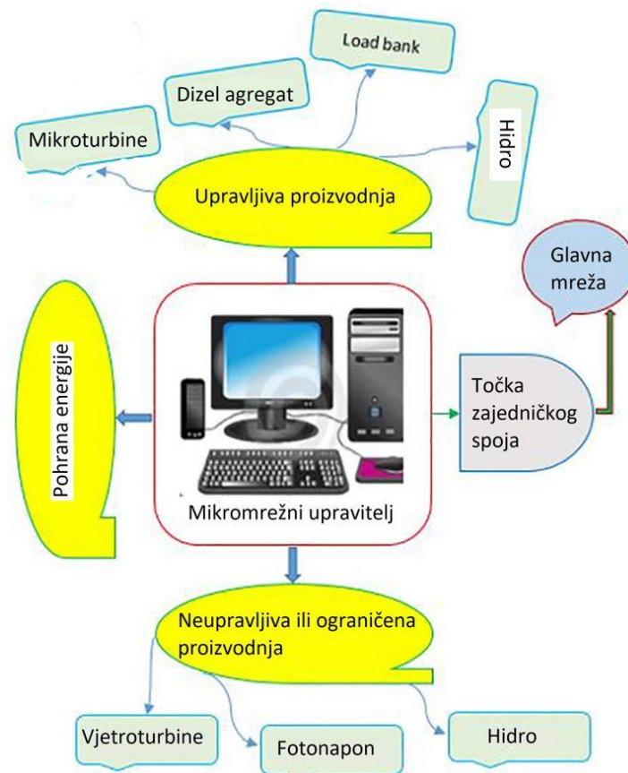
Slika 2-9 Shema mikromreže s različitim izvorima energije [6]
