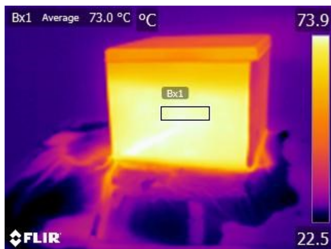
Slika 4.33. Termogram metalne kutije pri kutu 10° (-80°)
