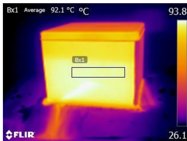
Slika 4.10. Termogram metalne kutije pri kutu 10^\circ ( -80^\circ )
