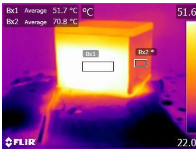
Slika 4.56. Termogram metalne kutije pri kutu 20° (-70°)
