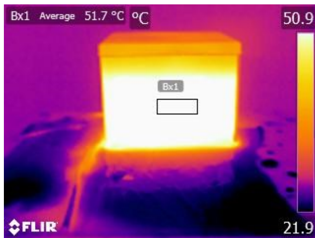
Slika 4.54. Termogram metalne kutije pri kutu 0° (-90°)
