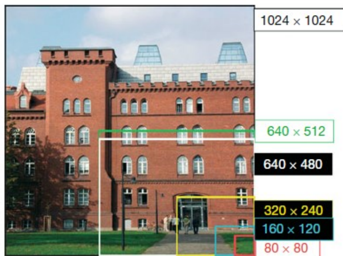
Slika 3.2. Prikaz različite razlučivosti IC termalnih kamera [1]
