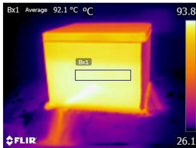
Slika 4.10. Termogram metalne kutije pri kutu 10^\circ ( -80^\circ )
