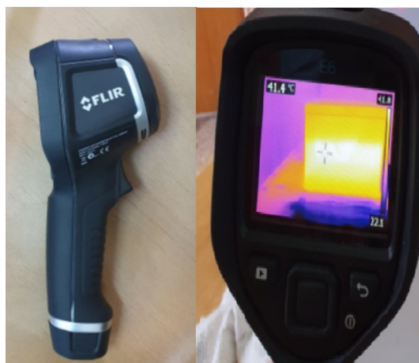
Slika 4.2 Termografska kamera FLIR E6
