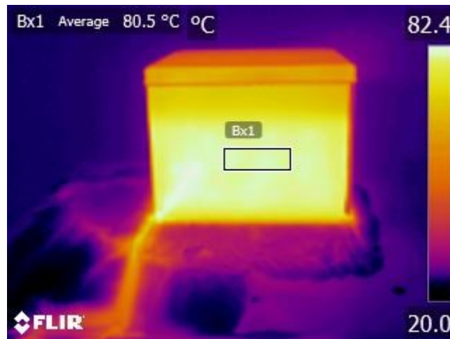
Slika 4.21. Termogram metalne kutije pri kutu 0° (-90°)
