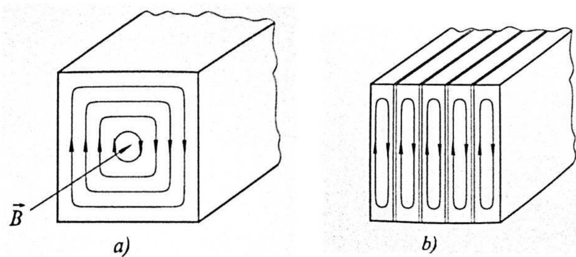
Slika 5.1. Vrtložne struje: a) u masivnom vodiču b) u tankim limovima [6]
