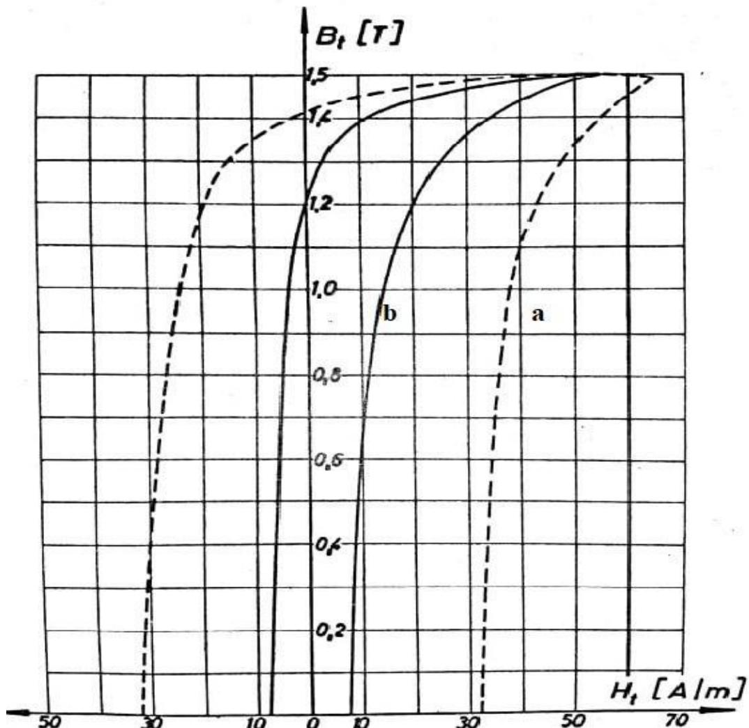
Slika 5.9. Petlja histereze lima „Armco-oriented M-6x“:
