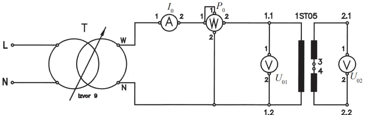
Slika 5.6. Shema spoja praznog hoda jednofaznog transformatora [12]
