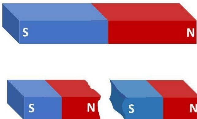
Slika 2.2. Dijeljenje magneta [2]
