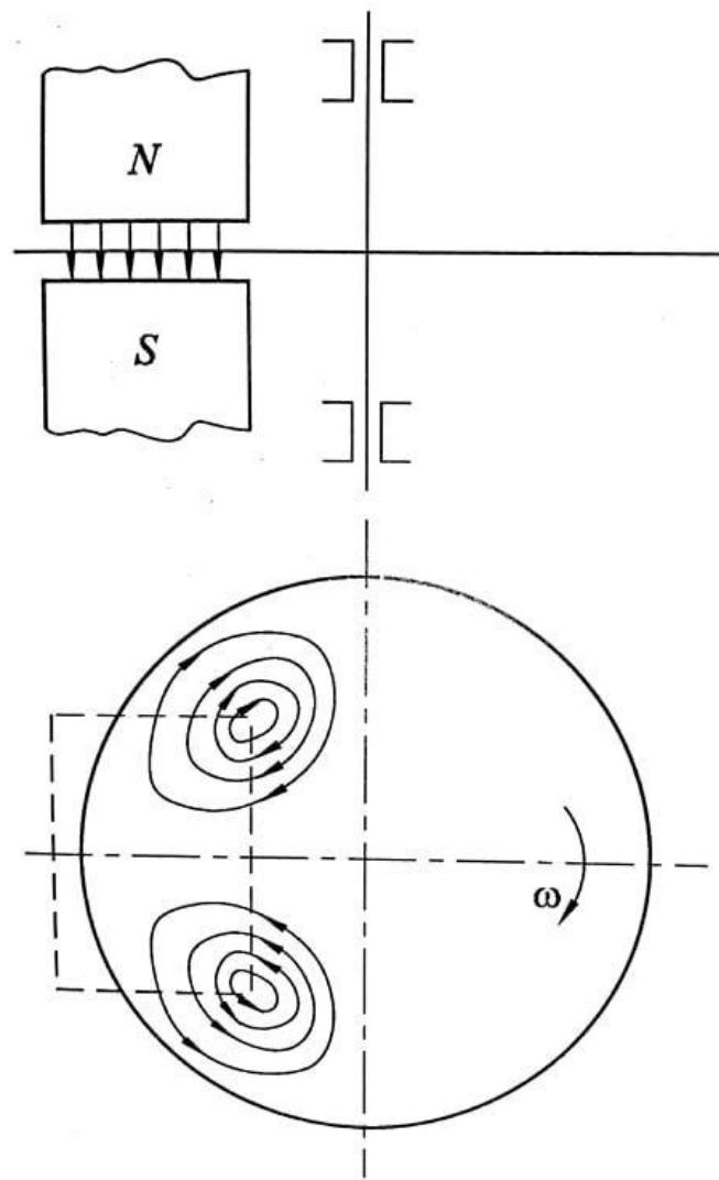
Slika 4.2. Kočenje metalnog diska električnog brojila [6]
