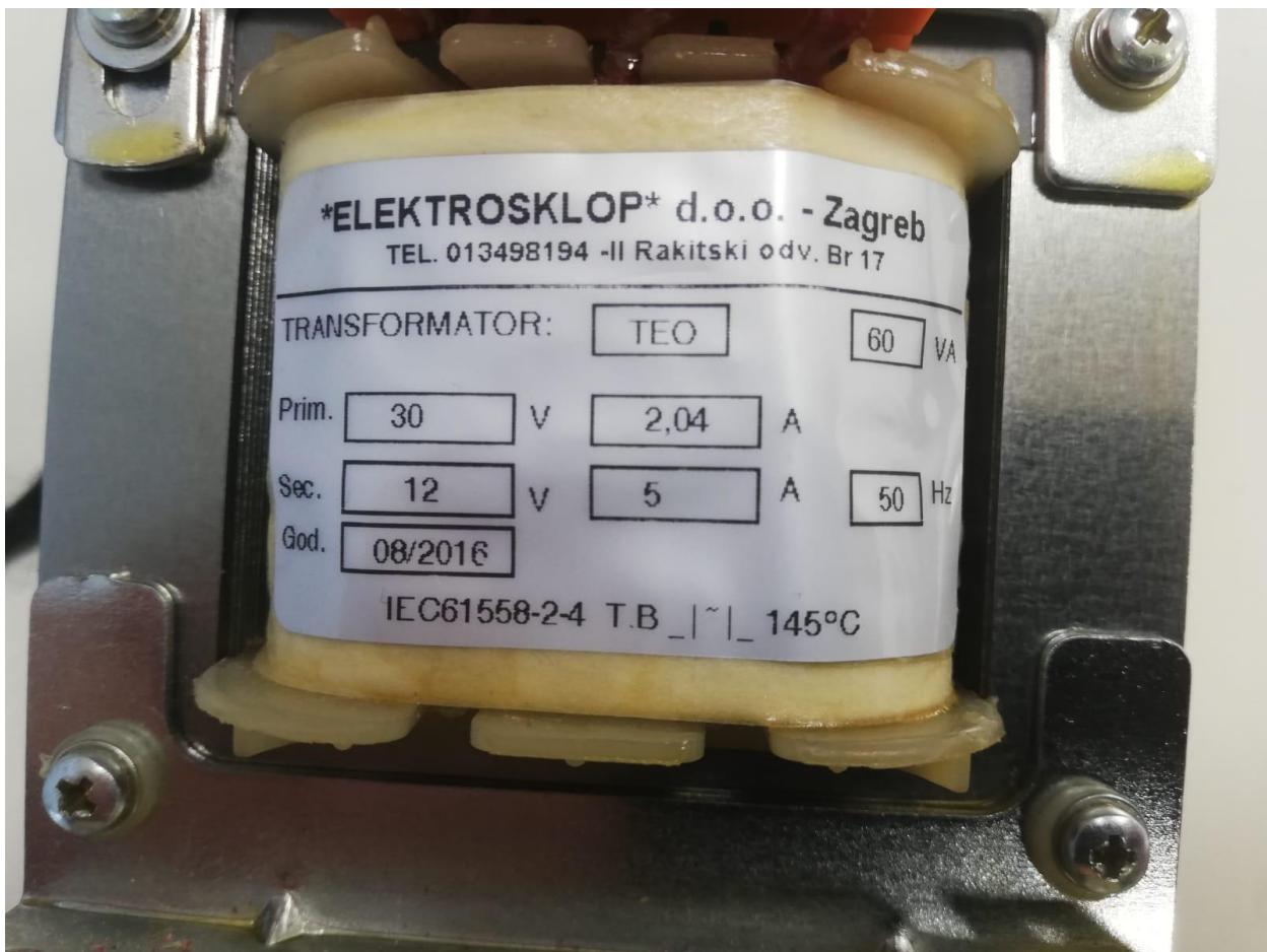
*Slika 7.1. Karakteristike transformatora*
