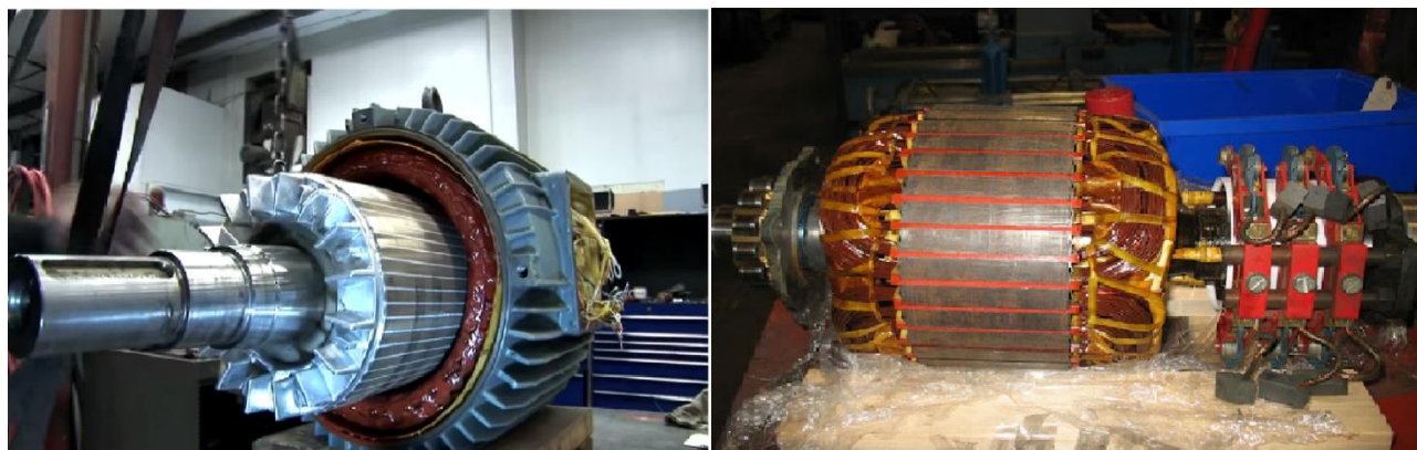
Slika 7.6. Trofazni asinkroni motor s kavezni rotorom lijevo i s kliznim prstenovima desno [51, 52].
