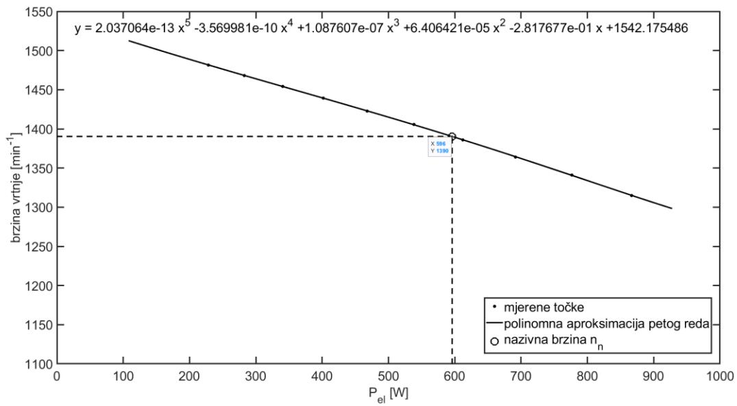
Slika 4.27 Ovisnost brzine vrtnje o električnoj snazi
