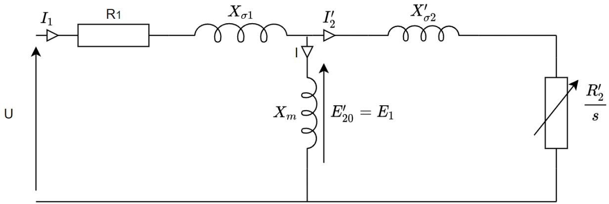
Slika 2.5. Nadomjesna shema asinkronog motora u ustaljenom stanju
