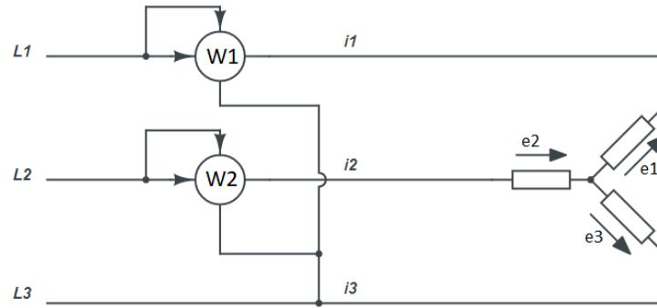
Slika 3.3. Aronov spoj za mjerjenje snage u trofaznom sustav
