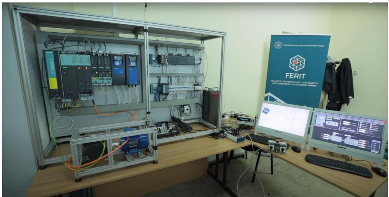
Slika 3.8. Stanica za automatizirano ispitivanje asinkronih motora
