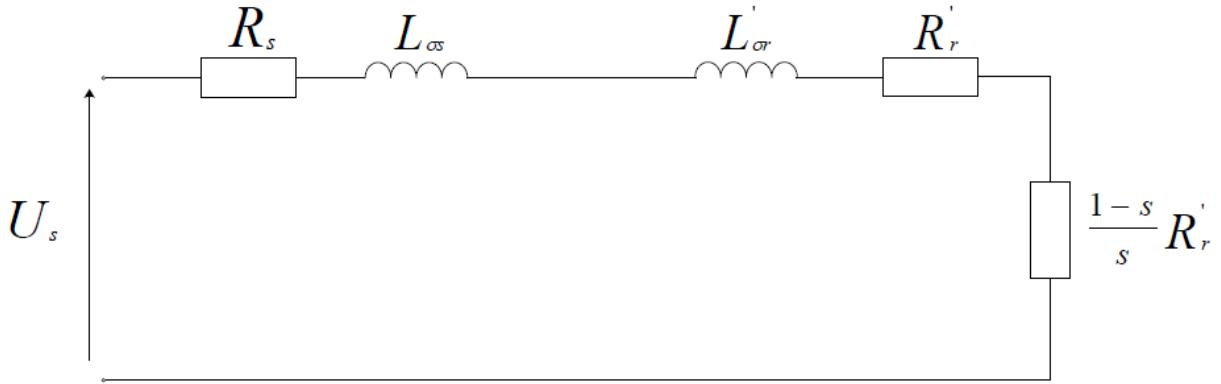
Slika 2.10. Nadomjesna shema asinkronog motora u kratkom spoju
