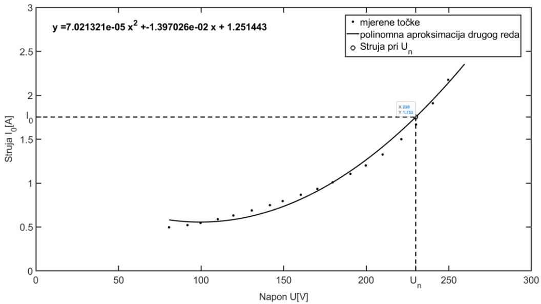
Slika 4.2 Ovisnost struje praznog hoda o naponu
