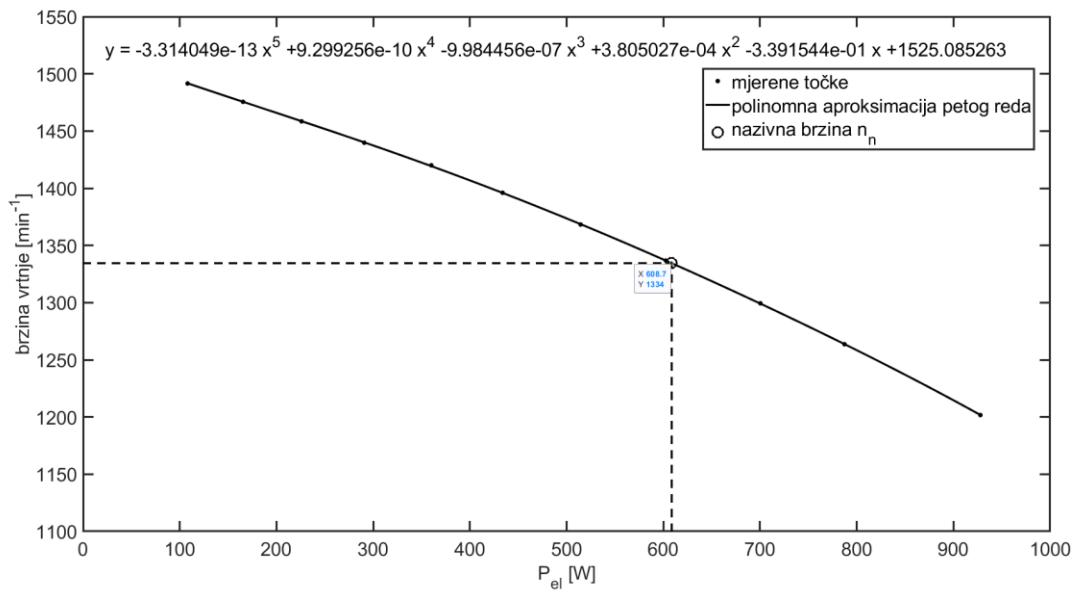
Slika 4.19 Ovisnost brzine vrtnje o električnoj snazi
