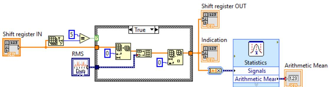
Slika 3.14. Dio koda koji računa efektivnu vrijednost po tzv. *moving average* principu
