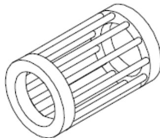
Slika 2.2.. Rotor kavezognog asinkronog motora[9]
