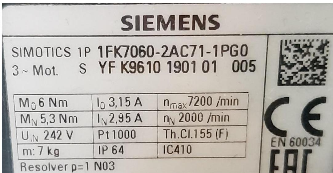
Slika 3.10. Natpisna pločica sinkronog motora
