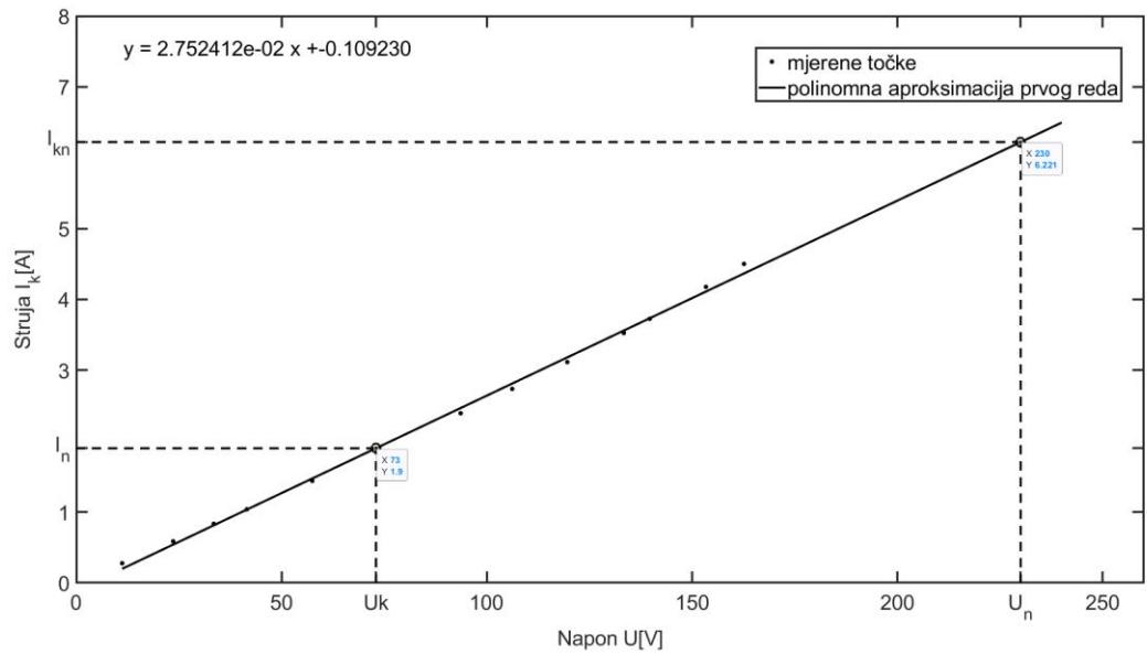
Slika 4.4 Ovisnost struje kratkog spoja o naponu
