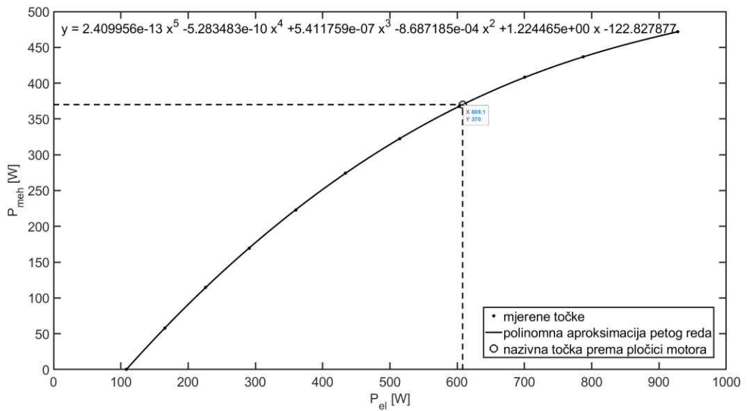
Slika 4.16 Ovisnost mehaničke snage o električnoj snazi
