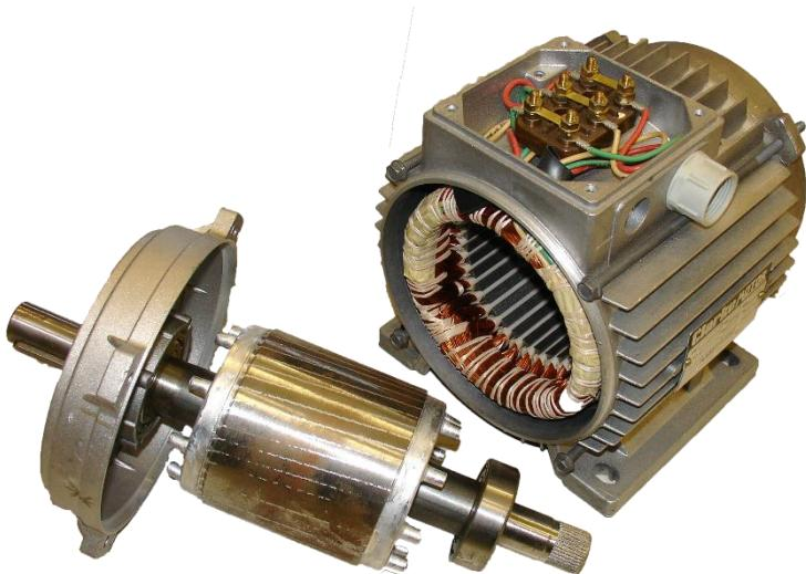
Slika 2.1. Asinkroni stroj sa razdvojenim rotorom (lijevo) i statorom (desno) [7]
