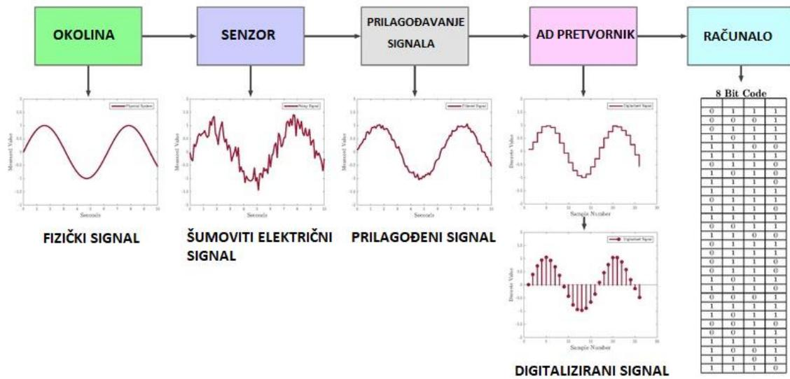
Slika 3.7. Postupak digitalizacije analognog signala
