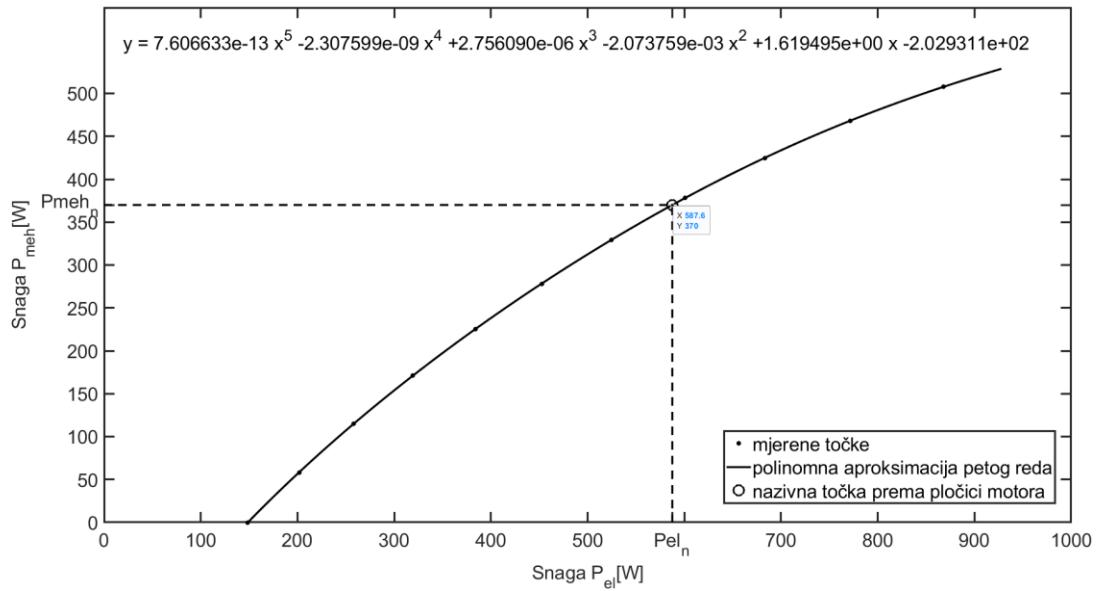
Slika 4.8 Ovisnost mehaničke i električne snage
