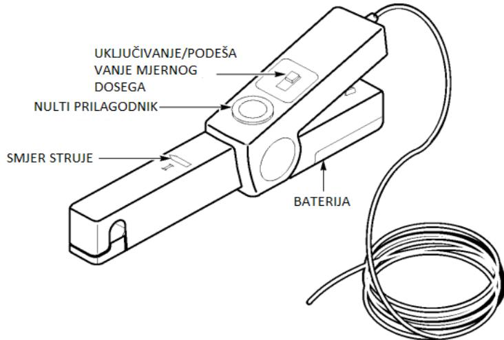
Slika 3.4. Mjerni član A622 sa osnovnim funkcijama[20]
