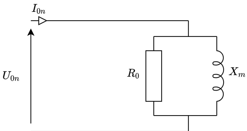
Slika 2.9. Nadomjesna shema asinkronog motora u praznom hodu
