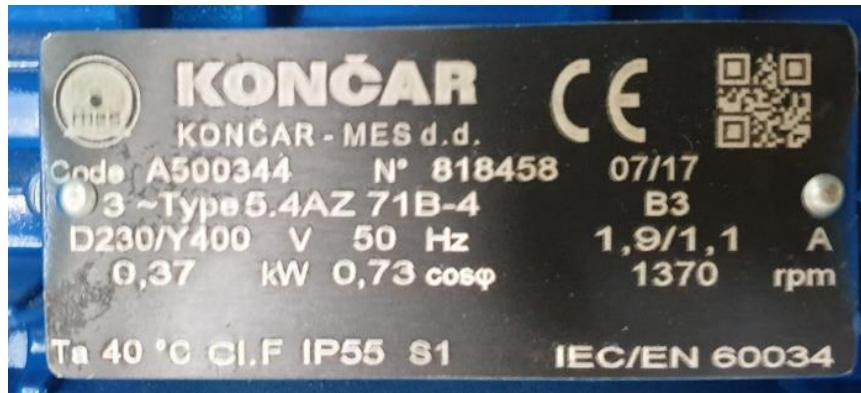
Slika 2.4. Natpisna pločica ispitivanog asinkronog motora
