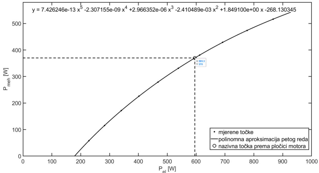
Slika 4.24 Ovisnost mehaničke snage o električnoj snazi
