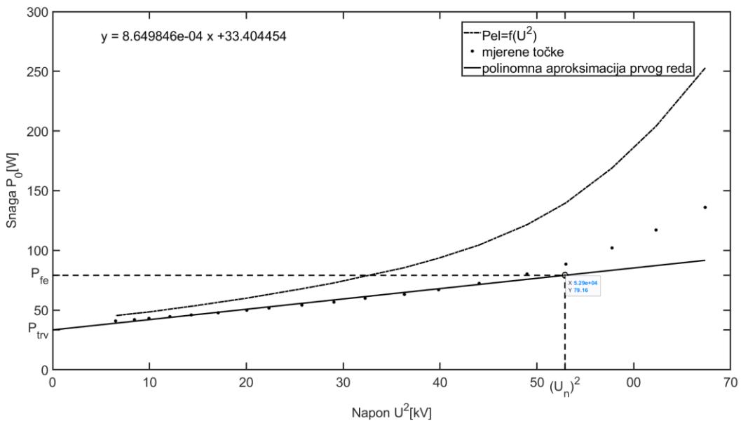
Slika 4.1 Ovisnost snage praznog hoda o kvadratu napona
