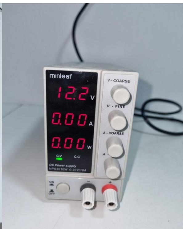
Slika 4.2. Istosmjerni izvor napajanja
