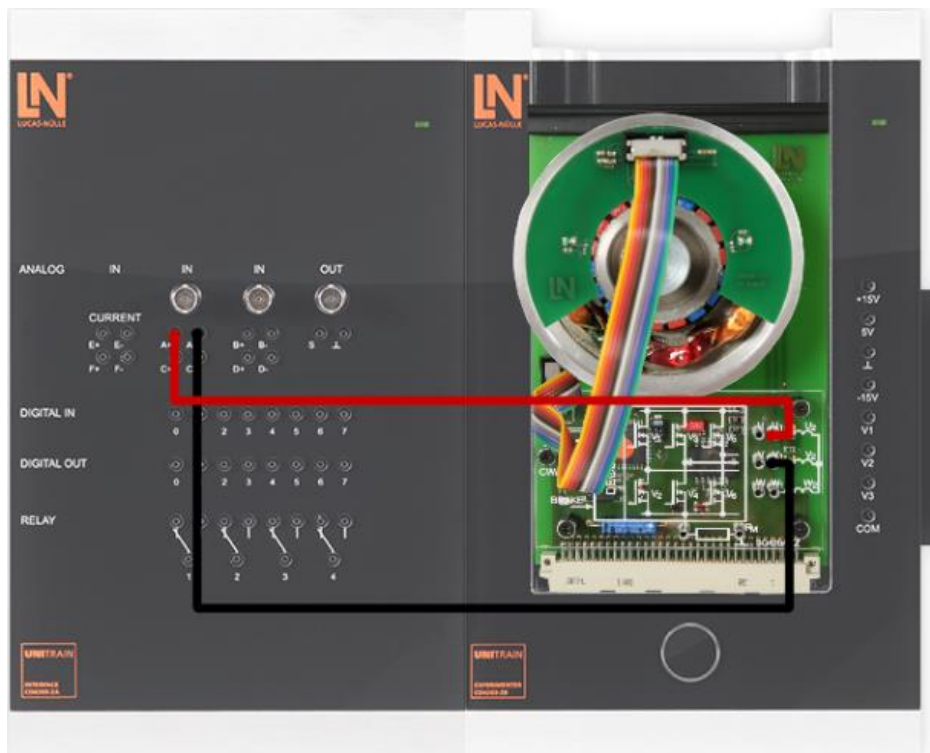
Slika 6.9. Shema spajanja za mjerenje inducirano napona
