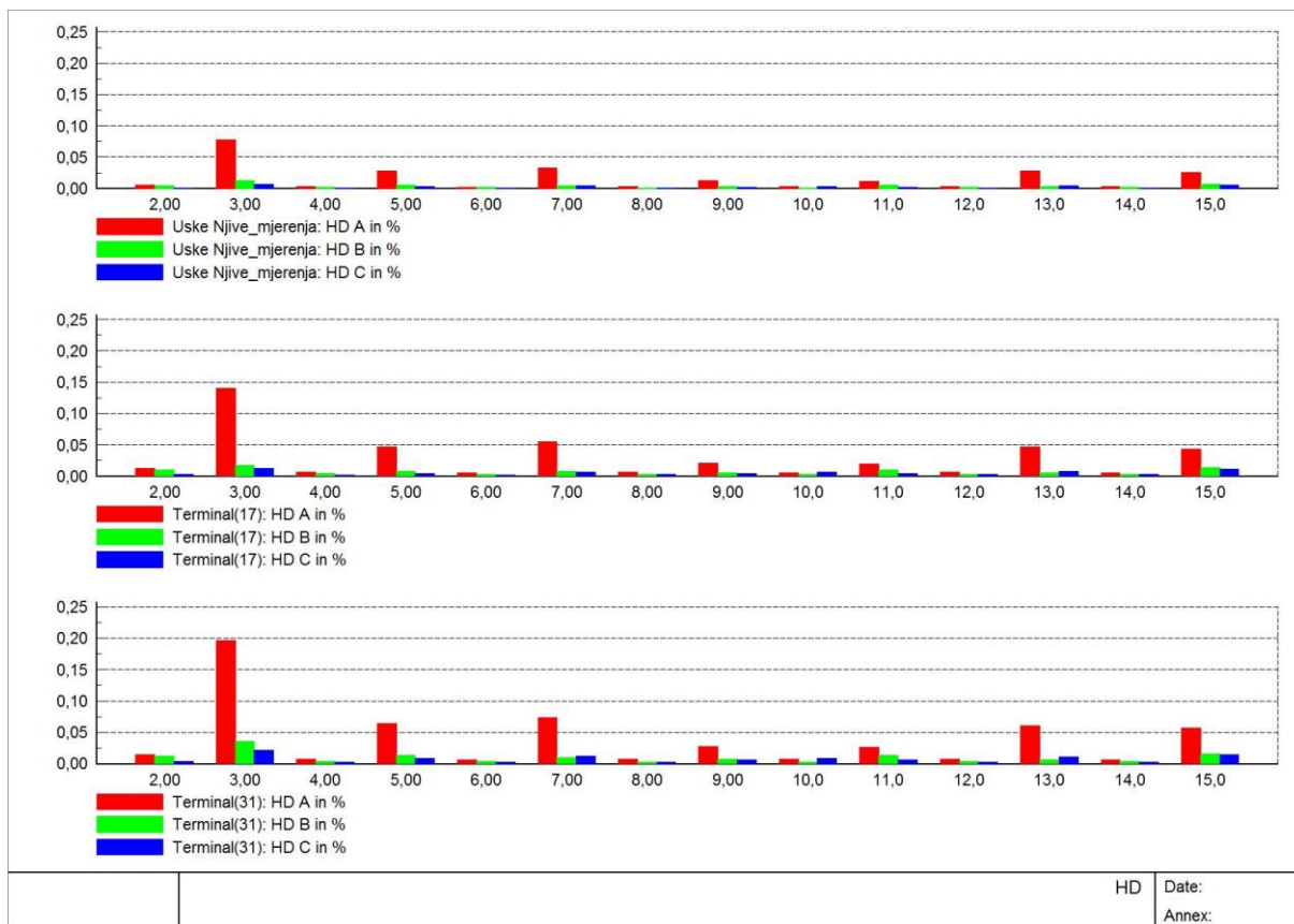
Slika 4.5. Prvih 15 harmonika u sve tri faze kod filtera na sredini izvoda
