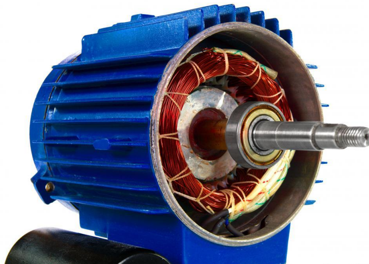
Slika 2.14. Indukcijski motor s prikazom statora i rotora [16]
