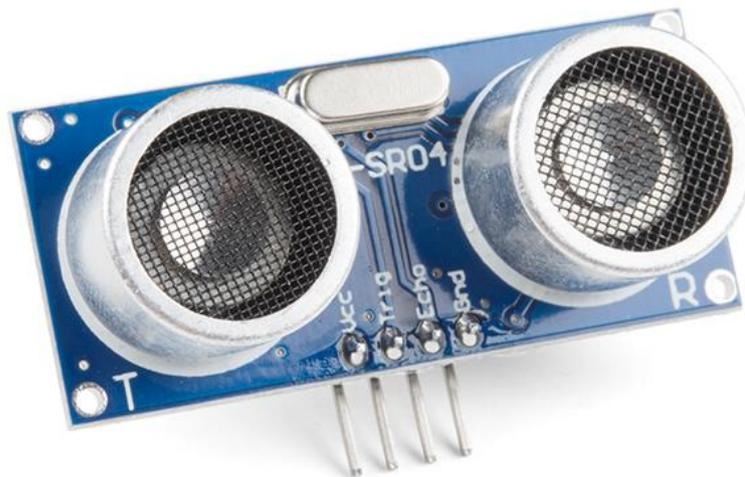
Sl. 3.1. Ultrazvučni senzor udaljenosti (HC-SR04) [9]
