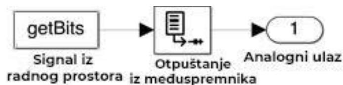
Sl. 5.4. Blok shema u Simulink-u za obradu izlaza iz VHDL-a kao digitalnog signala [12]
