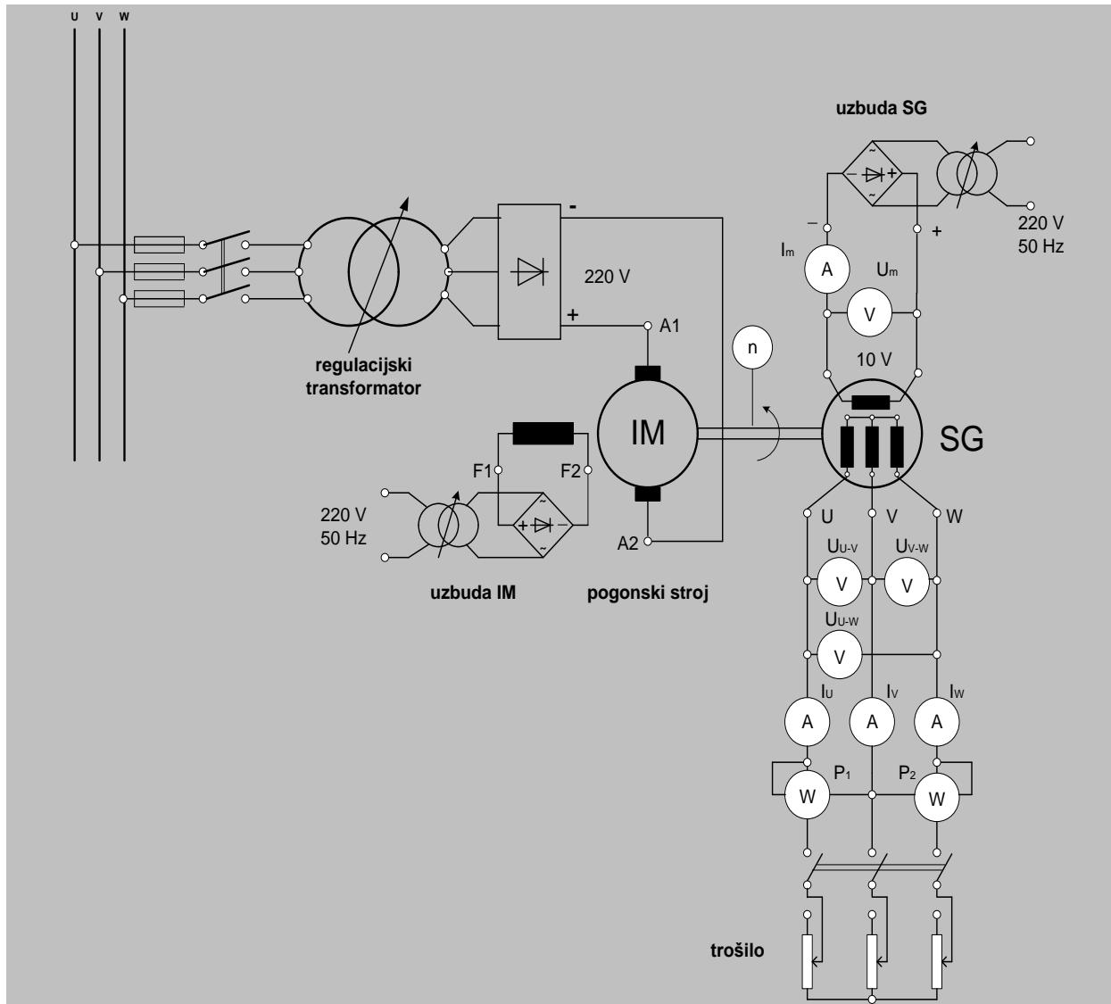
*Slika 4.3. Shema spoja za opterećenje sinkronog generatora. [11]*
