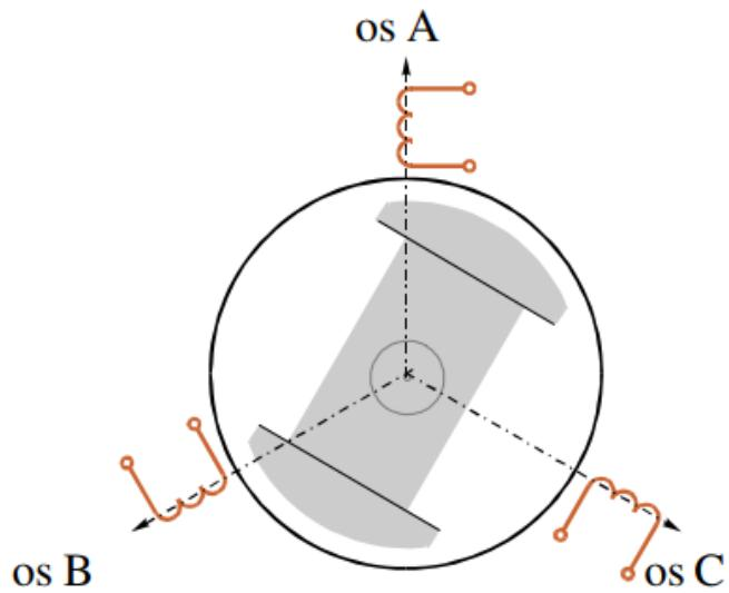
*Slika 2.11. Shematski prikaz triju osi namota armature međusobno pomaknute za  $120^\circ$ . [2]*
