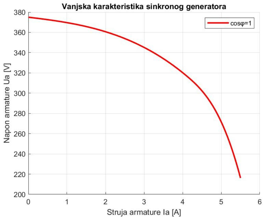
Slika 4.5. Prikaz vanjske karakteristike sinkronog generatora [7]
