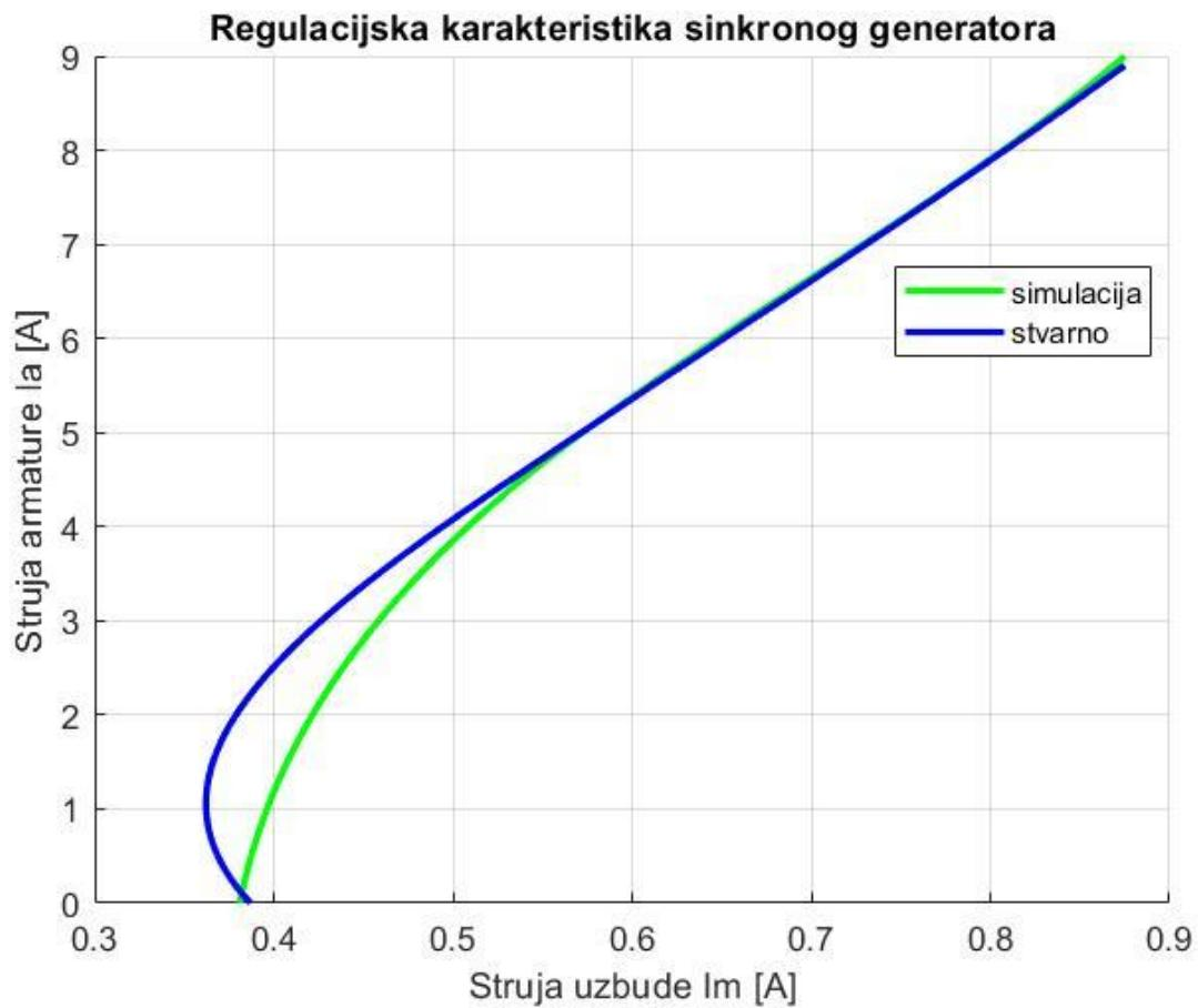
*Slika 5.4. Usporedba regulacijske karakteristike sinkronog generatora u simulaciji i stvarnom mjerenuju.[7]*
