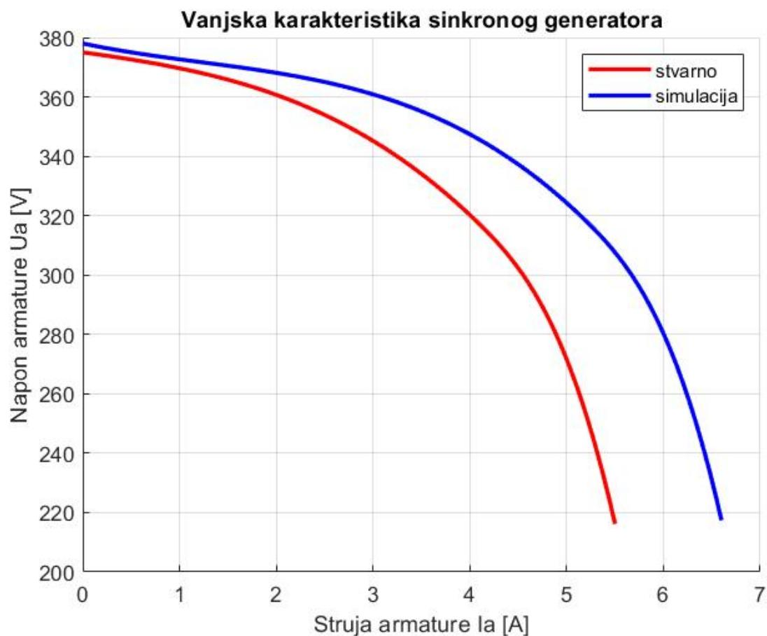
Slika 5.3. Usporedba vanjske karakteristike sinkronog generatora u simulaciji i stvarnom mjerenuju.[7]
