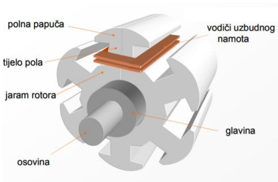
*Slika 2.8. Dijelovi rotora sinkronog stroja. [2]*
