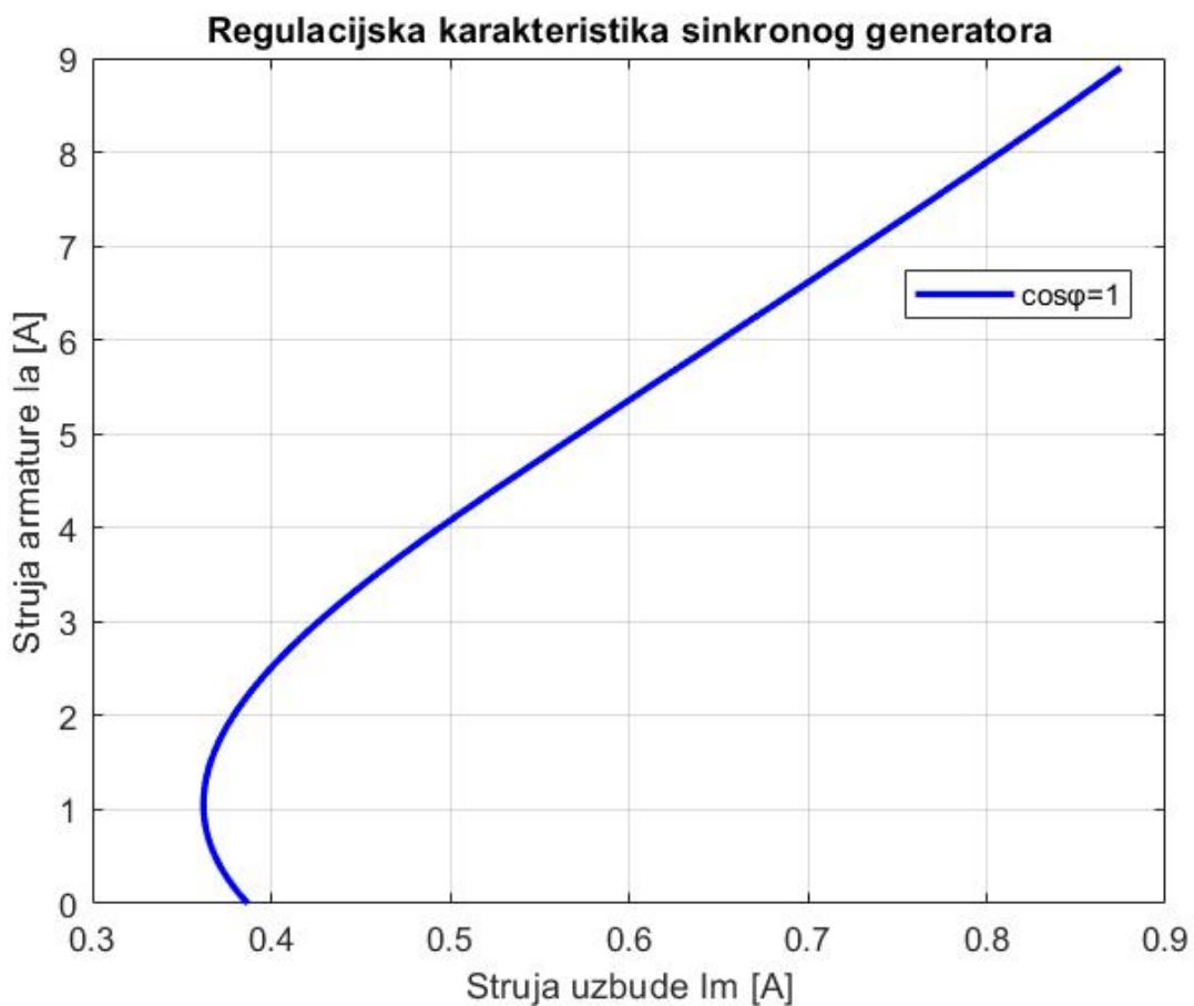
*Slika 4.6. Prikaz regulacijske karakteristike sinkronog generatora. [7]*
