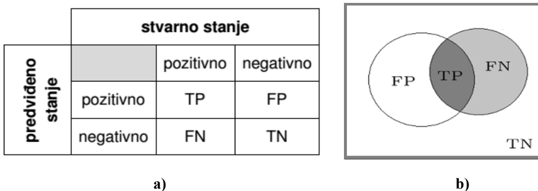
Slika 2.6. Tablica zabune binarnog klasifikatora prikazana a) tablično, b) dijagramima. [7]
