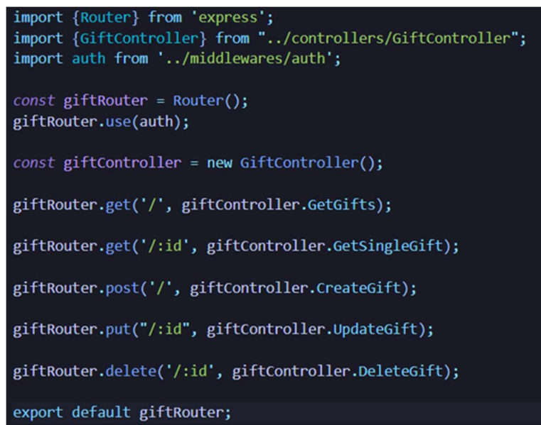
Slika 3.9. Datoteka GiftRouter.ts i prikaz njenih ruta.
