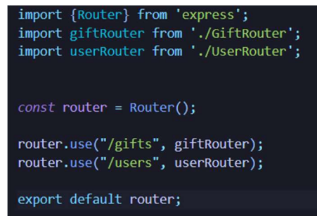
Slika 3.8. Primjer index.ts datoteke koja sadrži sve rute
