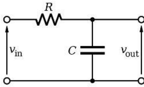
Slika 3.3.2. Električna shema niskopropusnog filtera 1. Reda
