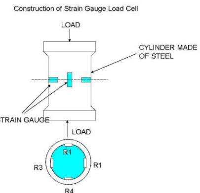
Slika 2.4.2. Mjerna ćelija senzora sile
