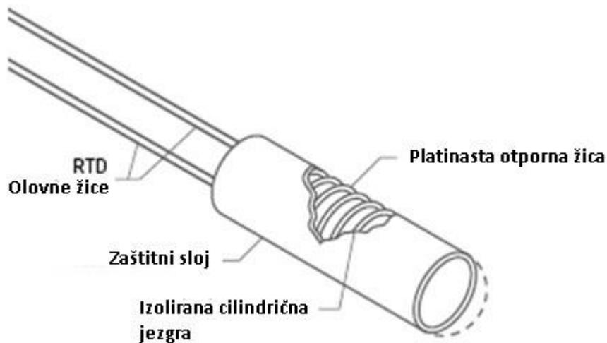
Slika 2.1.2. Platinski termootpornik
