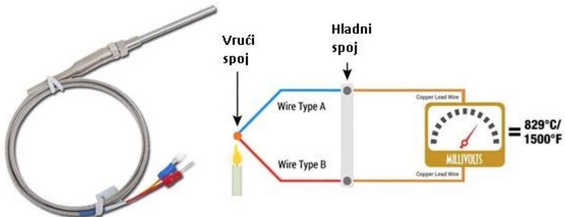
Slika 2.1.1. Termopar ili termoelement
