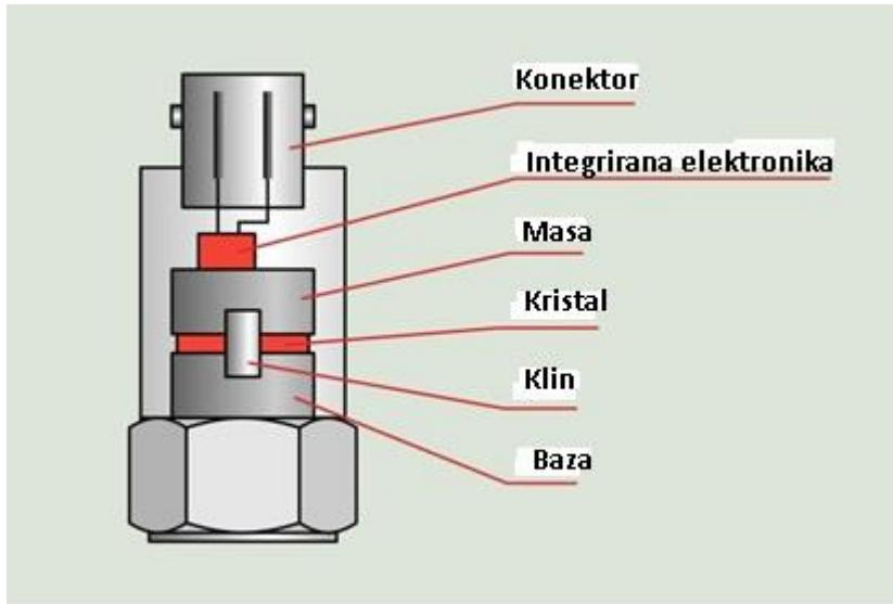
Slika 2.2.1. Piezoelektrični uređaj
