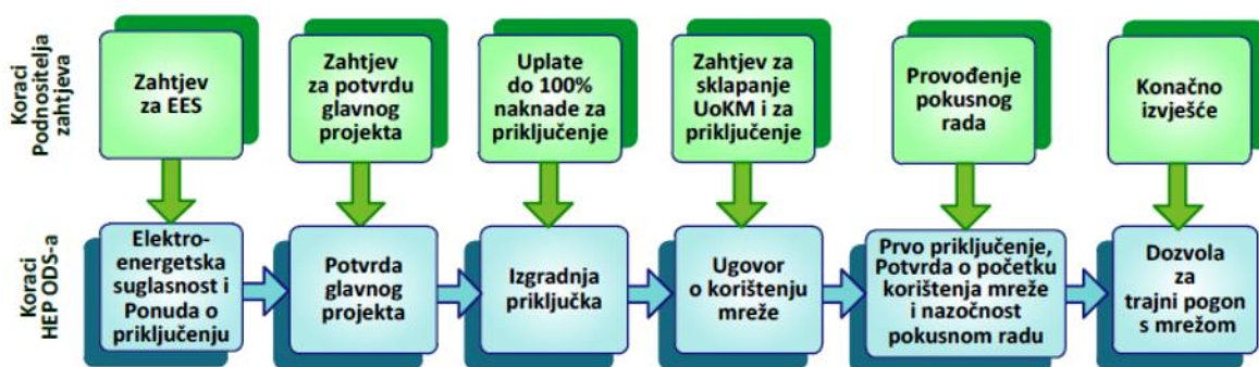
Slika 5.2. Pojednostavljeni priključak sunčane elektrane na mrežu HEP-ODS-a [25]
