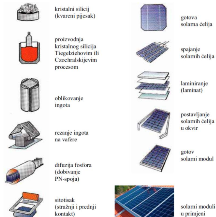
Slika 3.6. Postupak proizvodnje ćelija i fotonaponskih modula [13]
