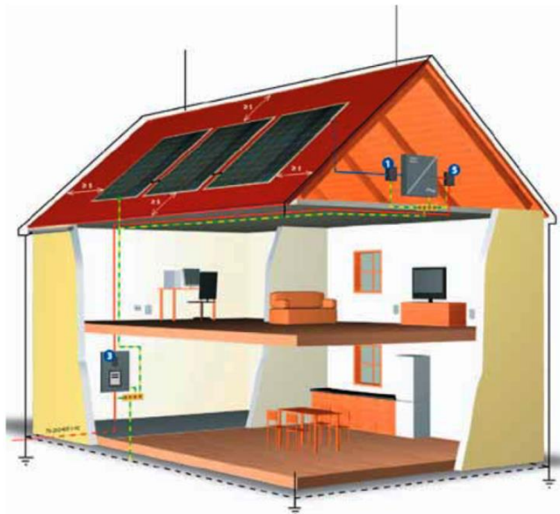
Slika 4.7. Fotonaponski sustav i instalacija sustava zaštite od udara munje [13]
