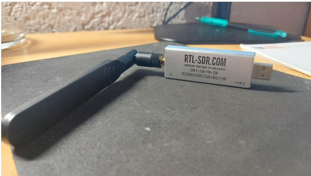
Slika 4.1. RTL-SDR uređaj s pripadajućom antenom
