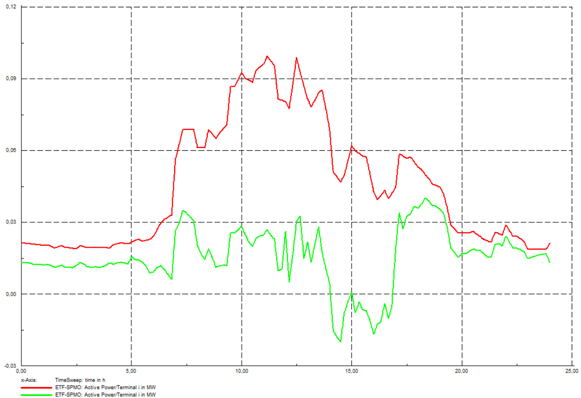
Slika 5.3. Promjena opterećenja kroz priključni vod (c-prije integracije, z-nakon integracije)
