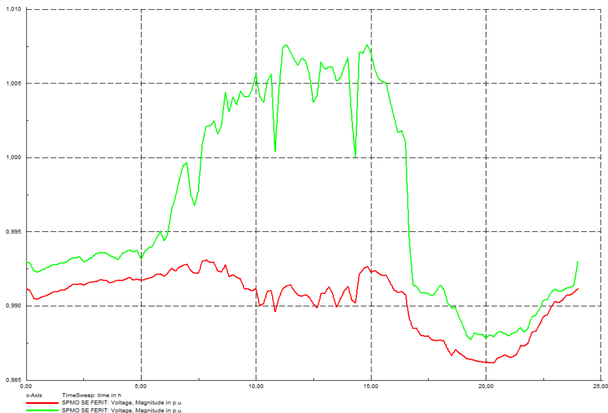
Slika 5.4. Promjena napona na sabirnici SPMO (c-prije integracije, z-nakon integracije)
