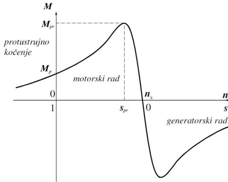
Sl. 2.8. Momentna karakteristika asinkronog stroja [2]
