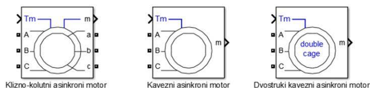
Sl. 3.8. Izvedbe rotora asinkronog motora
