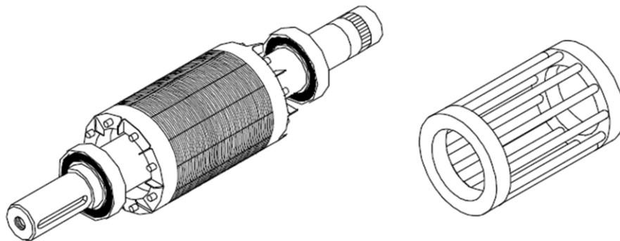
Sl. 2.5. Rotor i kavezni rotorski namot asinkronog motora [2]
