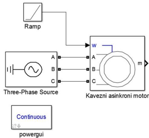
Sl. 3.18. Simulacijska shema zaleta motora bez prikaza vrijednosti
