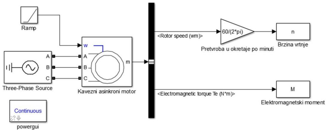
Sl. 3.19. Simulacijska shema zaleta s osnovnim vrijednostima
