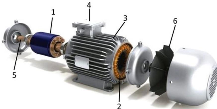
Sl. 2.1. Glavni dijelovi asinkronog motora [1]
