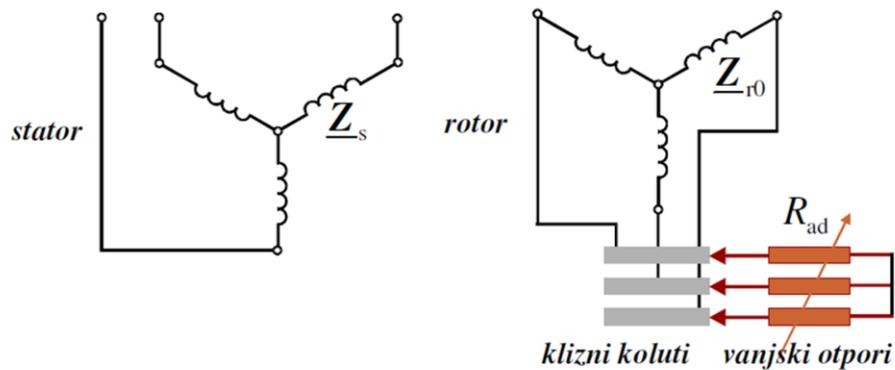
Sl. 2.4. Shematski prikaz klizno-kolutnog asinkronog motora [2]
