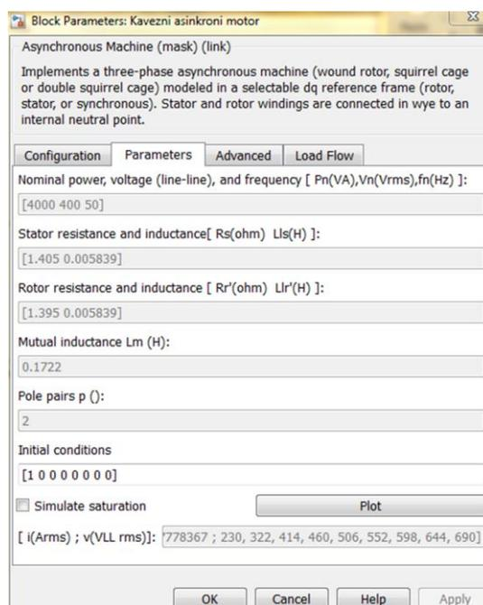
Sl. 3.10. Parametri asinkronog motora
