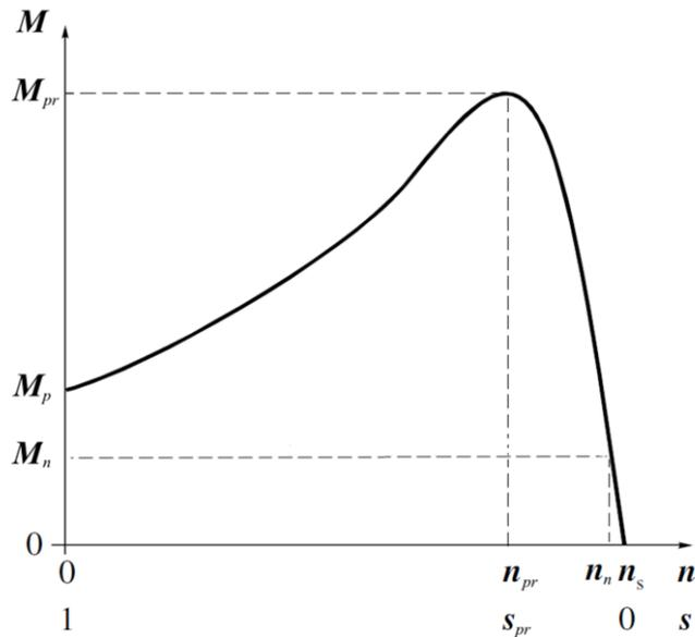
Sl. 2.9. Najčešći prikaz momentne karakteristike asinkronog motora [2]
