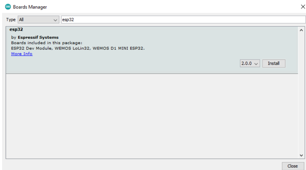
Sl. 4.5. Prikaz Boards Manager ekrana i esp32 paketa koji treba instalirati.
