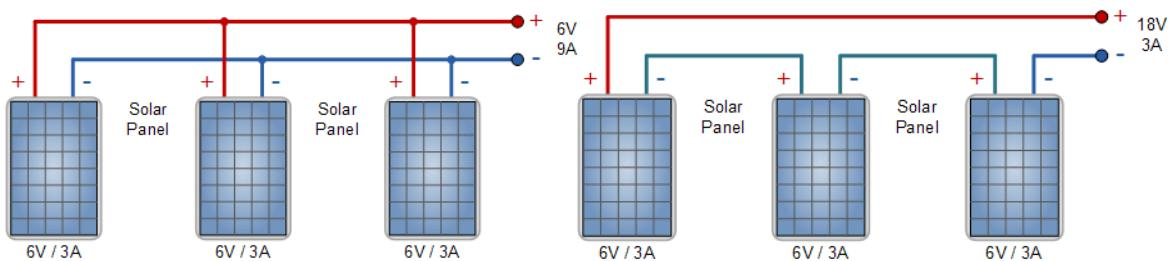
Slika 3.3. Primjeri serijskog i paralelnog spoja fotonaponskih panela [3]
