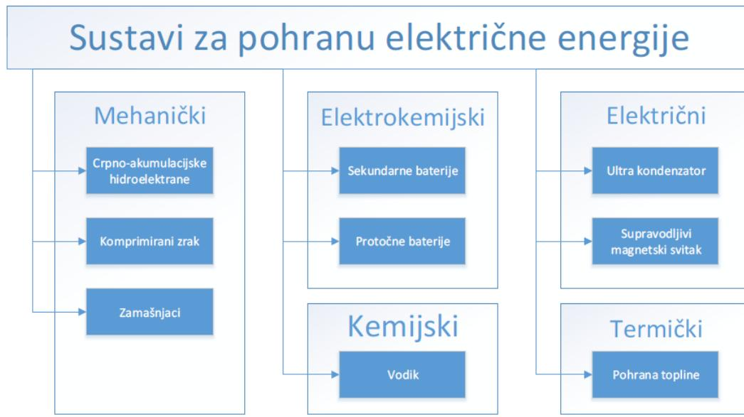
**Slika 4.1.** Podjela sustava za pohranu električne energije [6]
