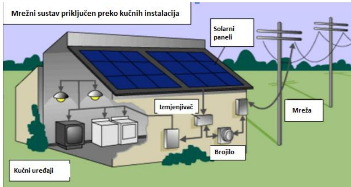
**Slika 3.6.** Fotonaponski sustav spojen na javnu elektroenergetsku mrežu preko kućne instalacije
