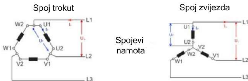
SL. 2.3: Shema spoja za spoj trokut i spoj zvijezda
