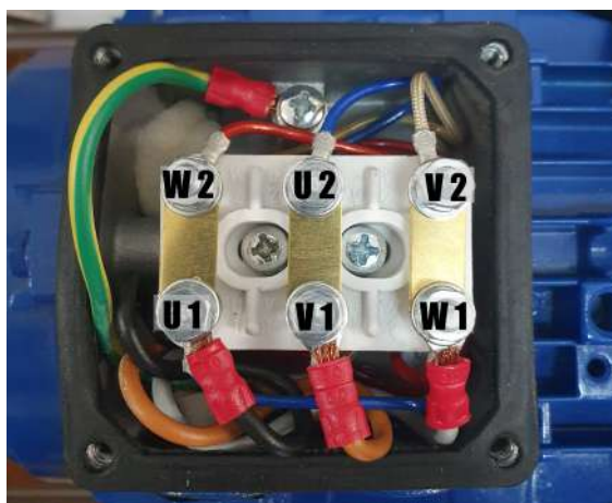
SL. 3.11: Oznake namota asinkronog stroja spojenog u trokut
