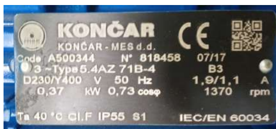
SL. 2.9: Natpisna pločica ispitivanog asinkronog stroja
