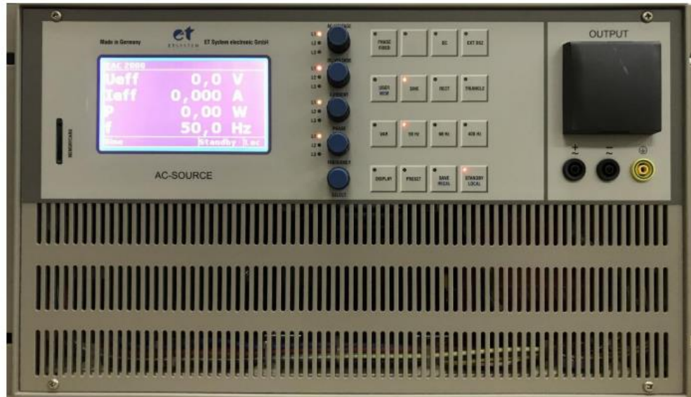
Slika 3.4. Izmjenični izvor ET System EAC-S2000.
