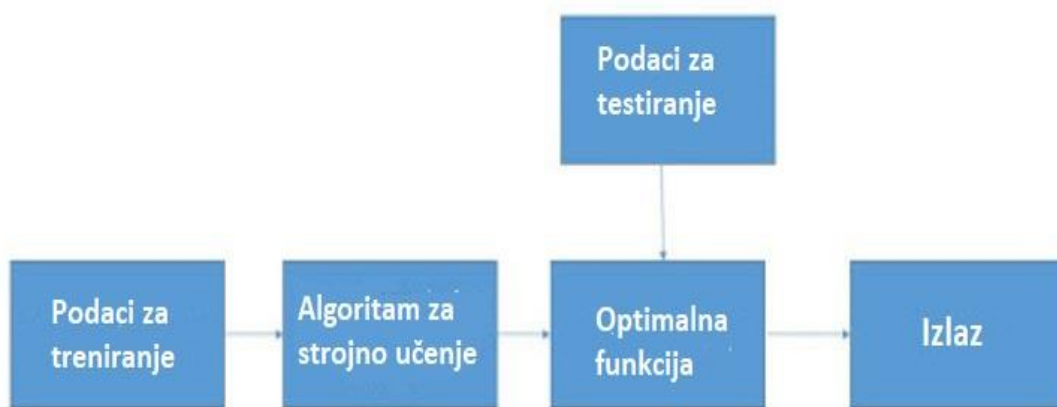
Slika 3.6. Princip rada strojnog učenja [14]
