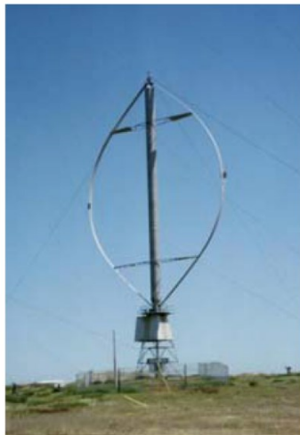
Slika 3: Vjetroatregat sa okomitim rotorom (lijevo) i vjetroatregat sa vodoravnim rotorom (desno) [1]
