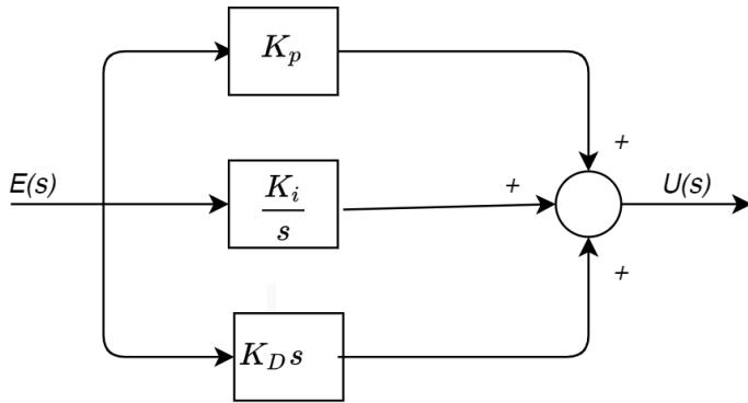
Sl. 2.3. Blok shema idealnog PID regulatora – paralelna [1]
