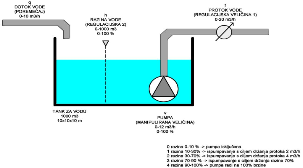
Sl. 3.1. Pojednostavljeni prikaz procesa uskladištenja tekućine spremniku pomoću crpke.
