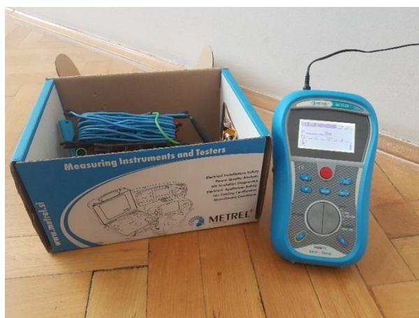
Slika 4.1. Mjerni instrument Metrel MI 3123
