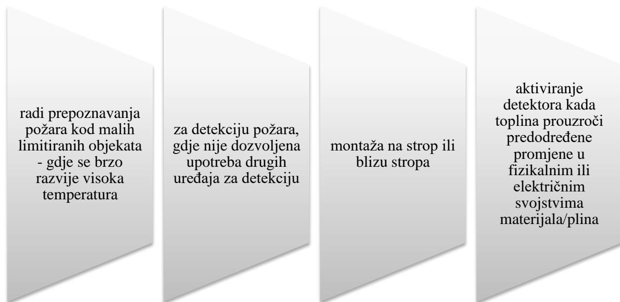
Slika 4.10. Osnovne karakteristike detektora topline
