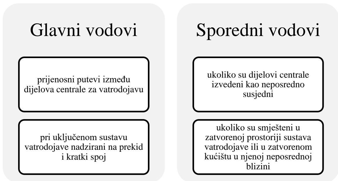
Slika 4.13. Vrste vodova kod sustava za dojavu požara [5, 7]
