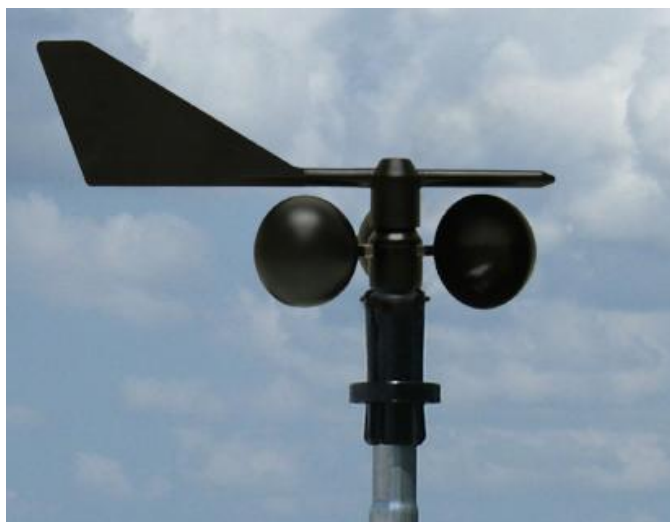
Slika 3.21. Anemometar i senzor smjera vjetra[26]
