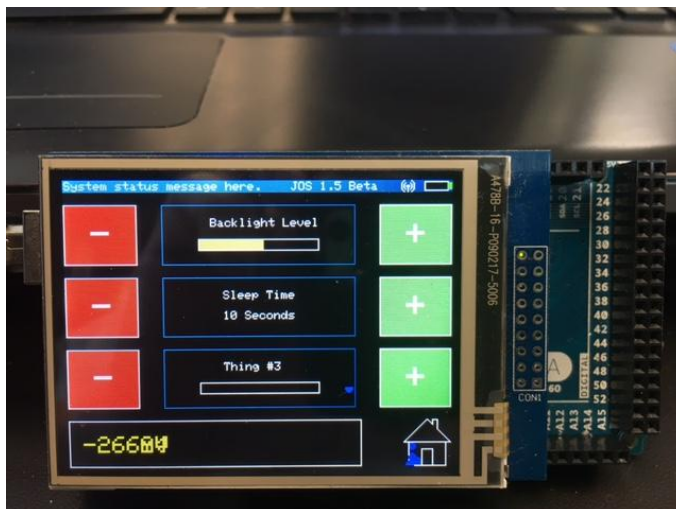
Slika 3.18. GUI sučelje s zaslonom osjetljivim na dodir na Arduino platformi [22]
