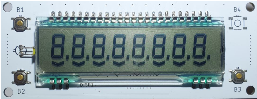
Slika 5.12. Test ispis LCD zaslona
