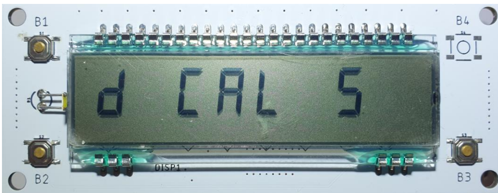
Slika 5.17. Kalibracija senzora smjera vjetra
