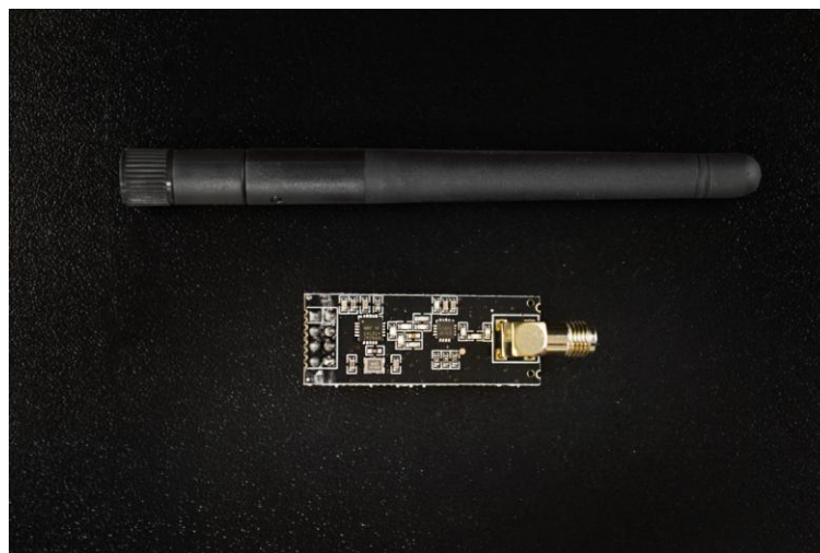
Slika 3.25. nRF24101 RF modul s pojačalom i antenom [31]
