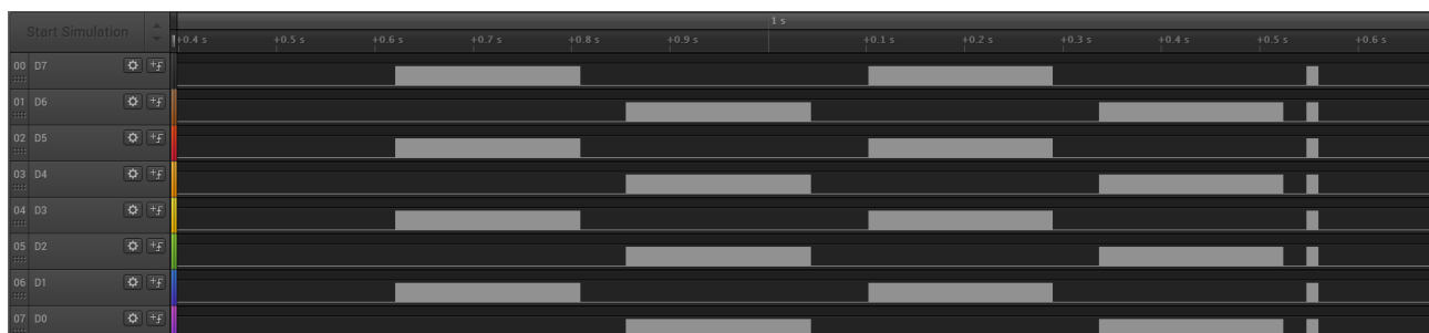
Slika 4.16. Ispravna sekvenca impulsa – čišćenje panela, podatkovna sabirnica
