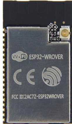
Slika 3.15. ESP32 WROVER modul [18]
