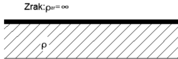
Slika 3.1. Model jednoslojnog (uniformnog) tla [2]
