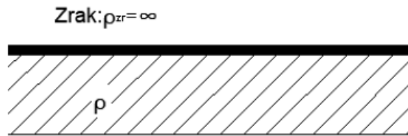
Slika 3.1. Model jednoslojnog (uniformnog) tla [2]
