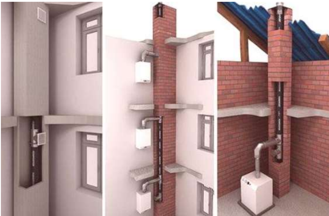
Slika 2.5. Postavljanje dimnjaka na plinski kotao, [10]
