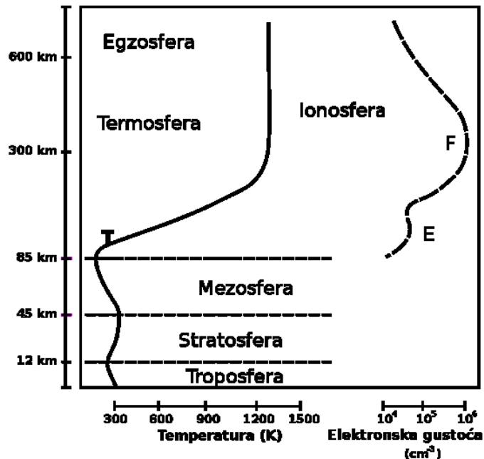
Sl. 4.16. Prikaz slojeva atmosfere i ionosfere. [26]
