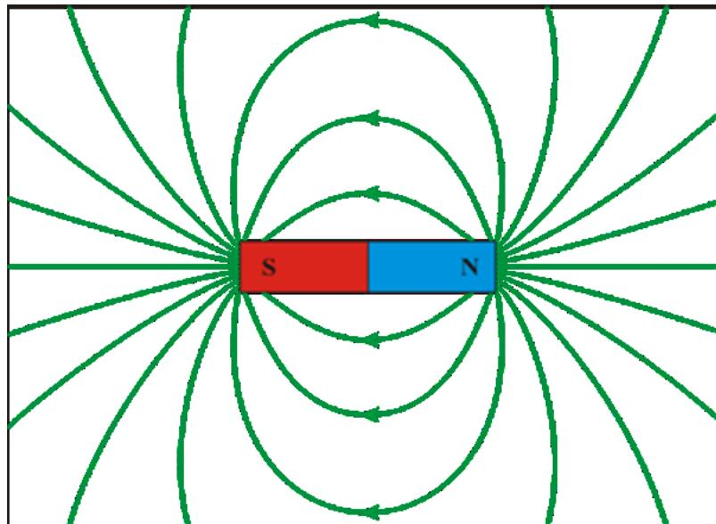
Sl. 3.8. Prikaz dipola sa silnicama magnetskog polja. [22]
