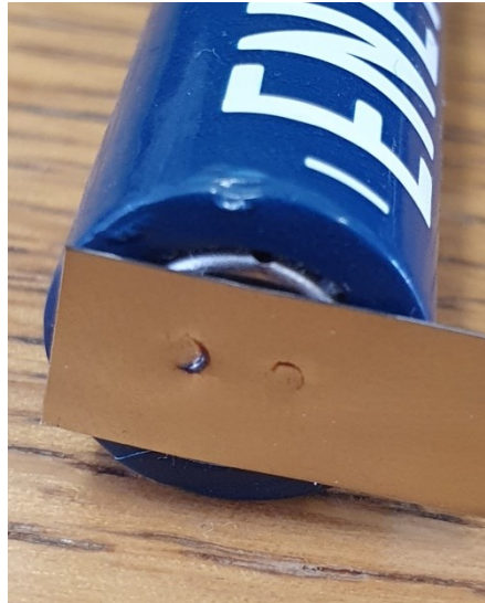
Slika 7.3.1. Spoj napravljen korištenjem 2 pulsa i razine jakosti struje 6
