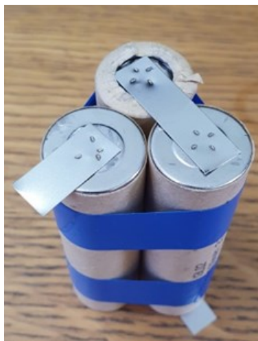
Slika 7.5.5. Izrađen serijski baterijski spoj s dodatnim točkastim zavarom
