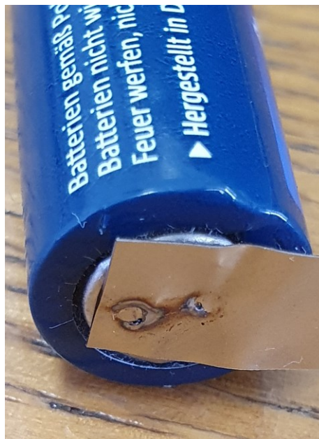
Slika 7.3.4. Spoj napravljen korištenjem 8 pulseva i razine jakosti struje 4
