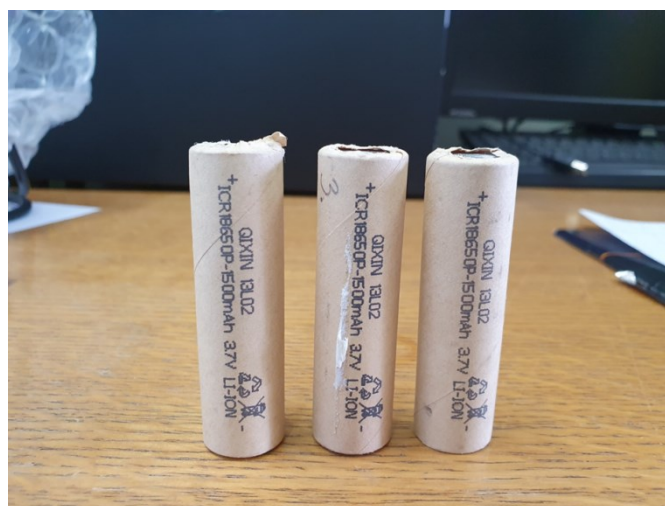
Slika 7.5.1. Tri litij-ionske baterije 18650 korištene za izradu serijskog baterijskog spoja
