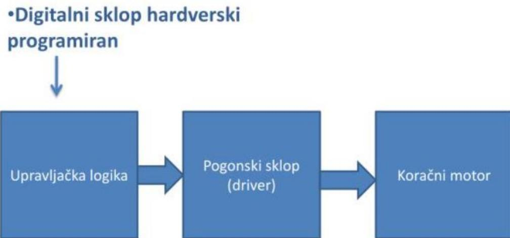
Slika 7.1. Blok prikaz koračnog pogona[10]
