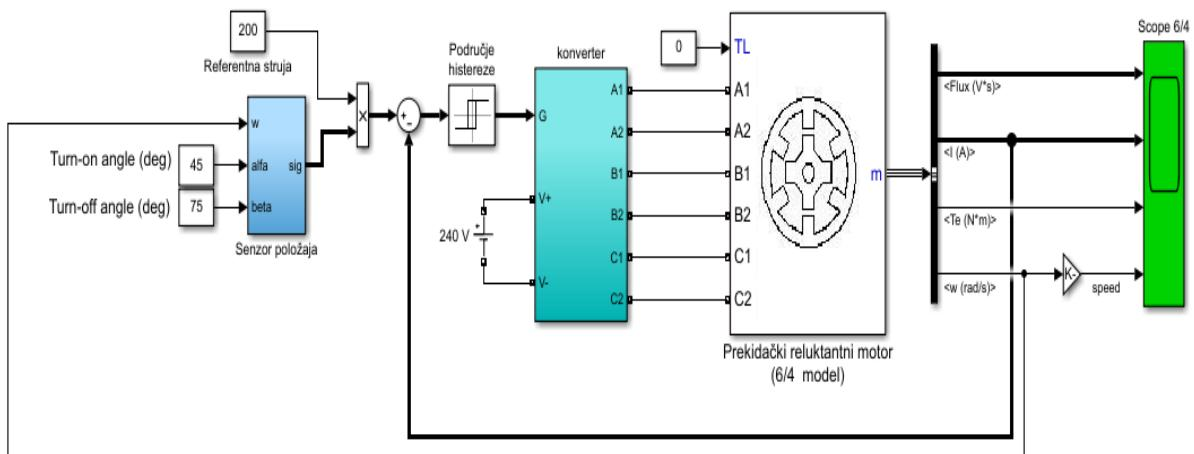
Slika 4.2.1 Prikaz blok sheme prekidačkog reluktantnog motora u MATLAB-u
