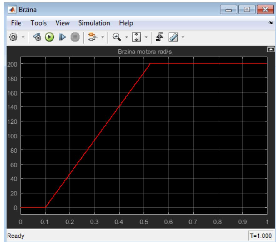
Slika 4.2.12 Grafički prikaz brzine sinkronog reluktantnog motora
