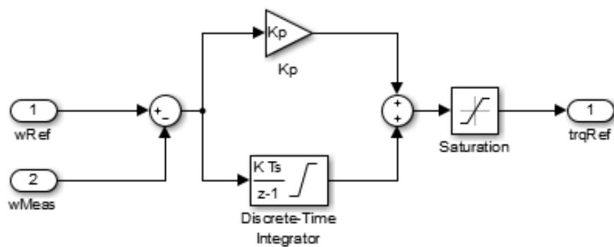
**Slika 4.2.8** Detaljni prikaz unutar bloka kontrolera brzine sinkronog reluktantnog motora
