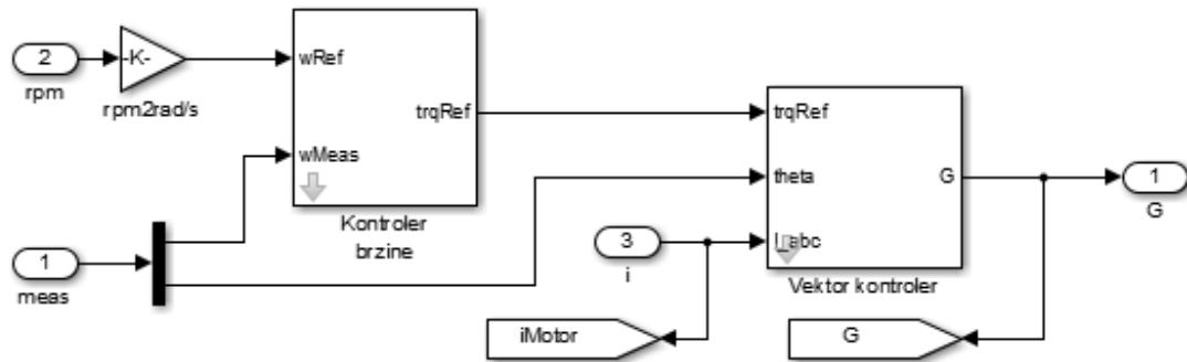
**Slika 4.2.7** Prikaz blok shema od kojih se sastoji SynRM kontroler
