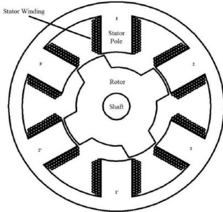
**Slika 3.1.1** Stator i rotor prekidačkog reluktantnog motora [6]
