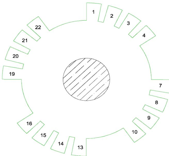
FIG A : ROTOR OF THE RELUCTANCE MOTOR
