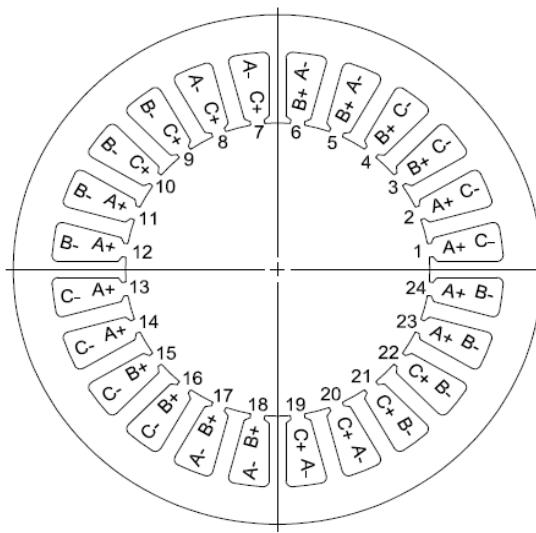
Slika 3.2.1 Trofazni stator sinkronog reluktantnog motora [10]
