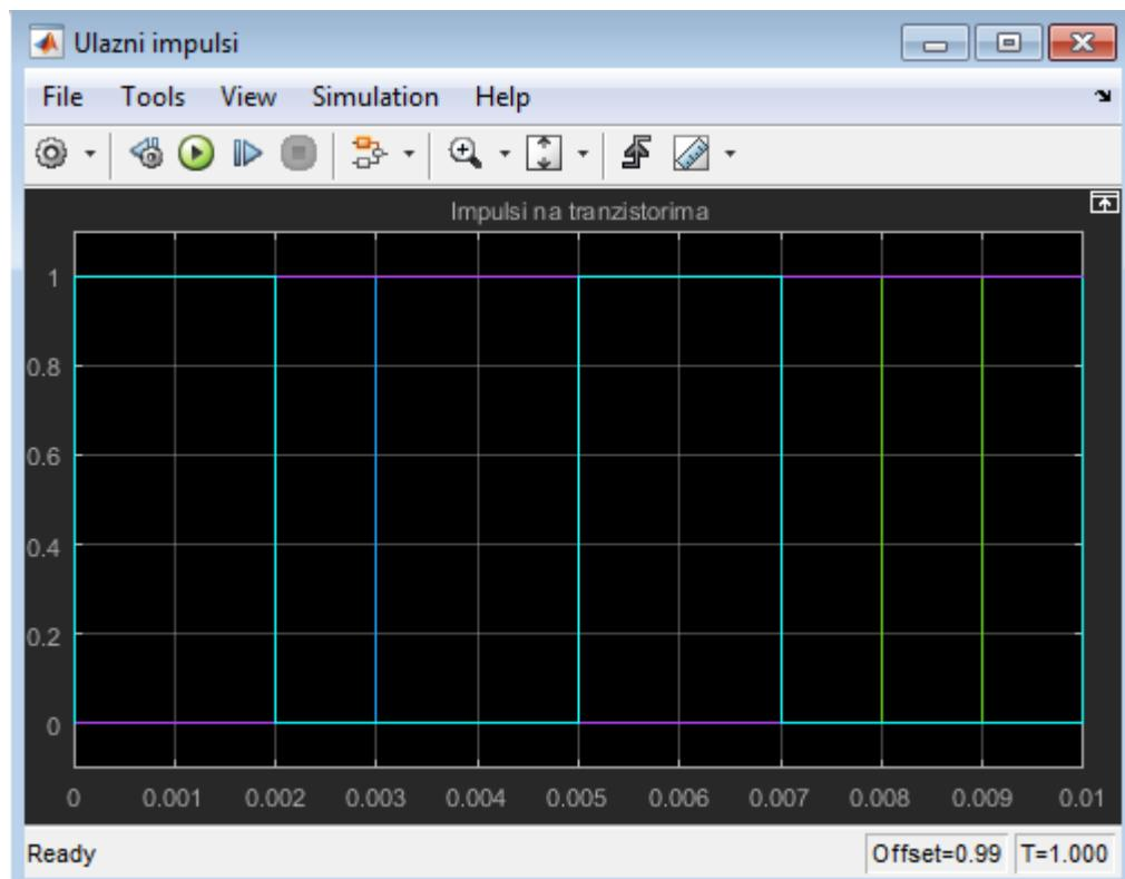
**Slika 4.2.14** Grafički prikaz impulsa tranzistora sinkronog reluktantnog motora
