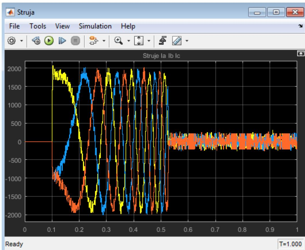
**Slika 4.2.13** Grafički prikaz struja statora sinkronog reluktantnog motora
