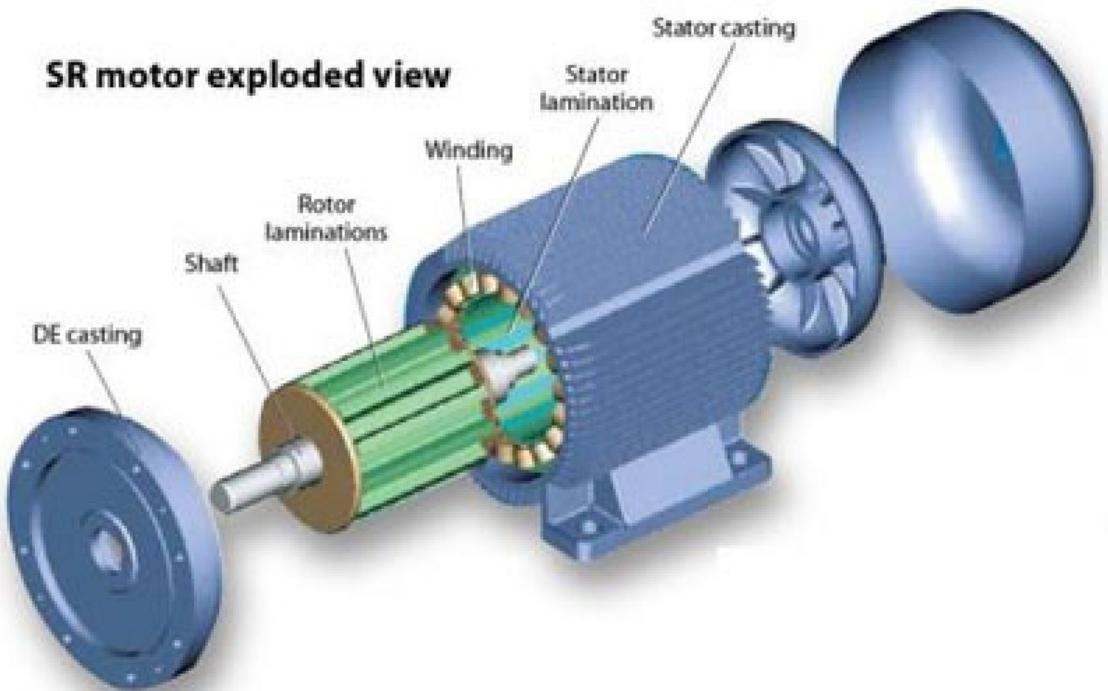
Slika 2.1.1 Konstrukcija reluktantnog motora [2]
