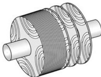
Slika 3.2.4 Poprečno lamelirani rotor [11]
