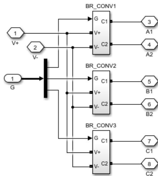
**Slika 4.2.2** Prikaz blok shema unutar konvertera
