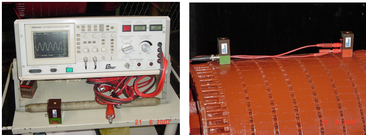
Slika 5.8. a) BAKER instrument; b) Položaj senzora za ispitivanje provodnosti štapova
