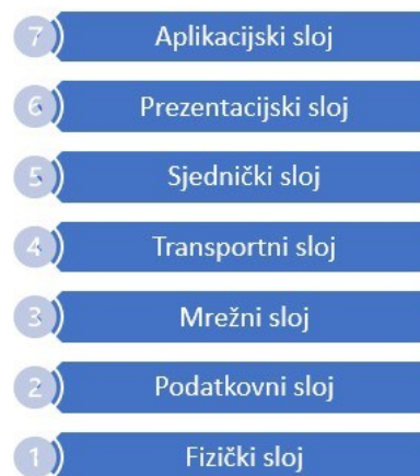
Slika 1. Slojevi OSI referentnog modela
