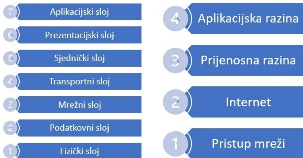
Slika 3. Odnos OSI referentnog modela i TCP/IP arhitekture
