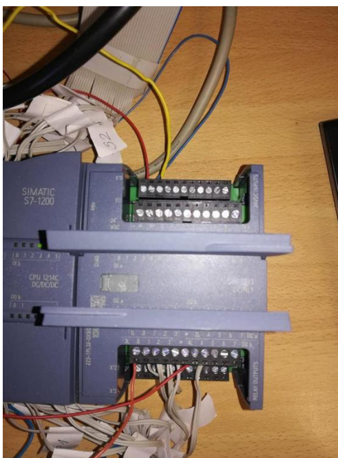
Slika 3.2.: Signalni modul SM 1223 DI16/DQ16
