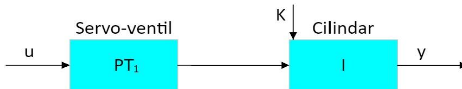
Slika 3.4. Model procesa za podešavanje parametara PI regulatora.
