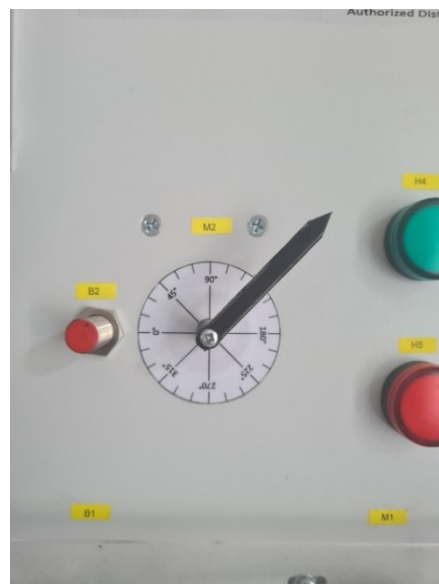
Sl 4.20 Pozicija servomotora nakon pokretanja za 180°
