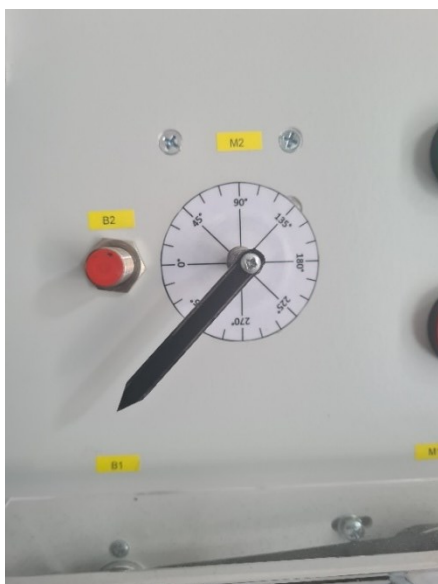
Sl 4.19 Pozicija servomotora prije pokretanja za 180°
