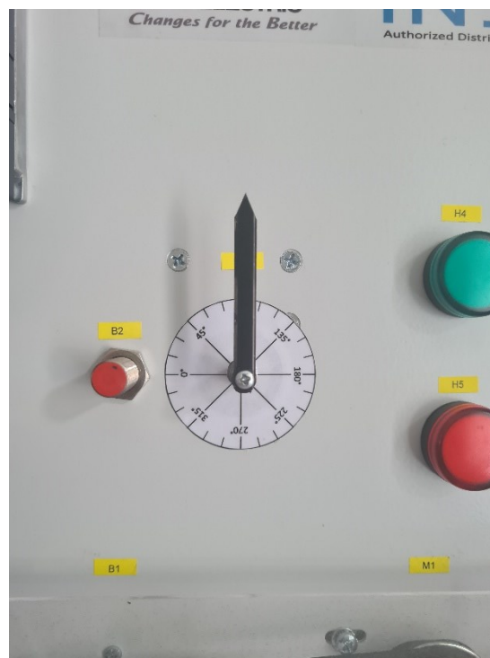
Sl 4.23 Pozicija servomotora nakon pokretanja za 90°
