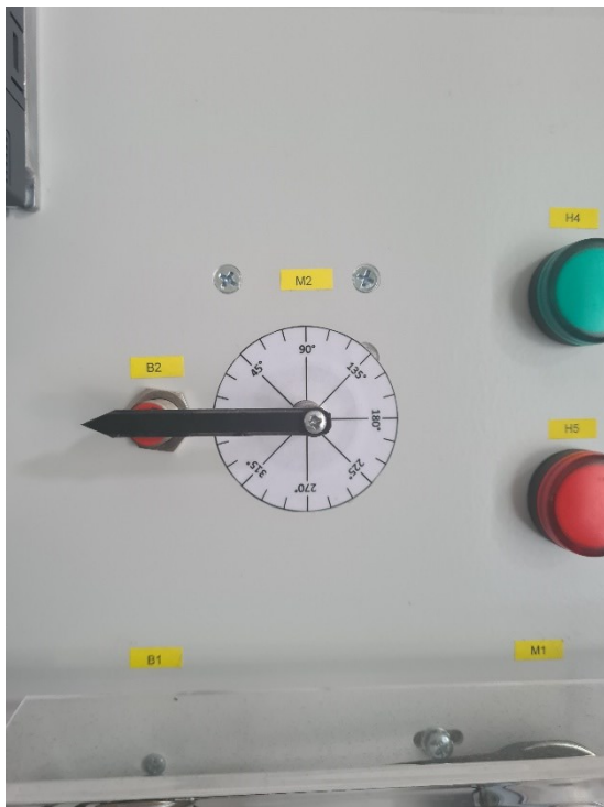
Sl 4.22 Pozicija servomotora prije pokretanja za 90°
