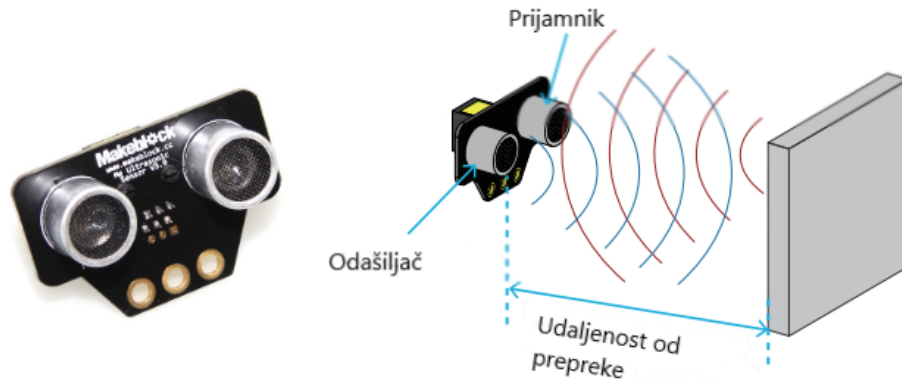
Slika 2.6 Izgled i funkcioniranje rada ultrazvučnog senzora prema izvoru, [10]
