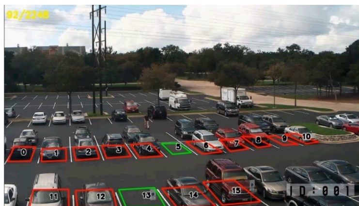
Slika 2.4 Uporaba kamere za upravljanje parkingom, [8]
