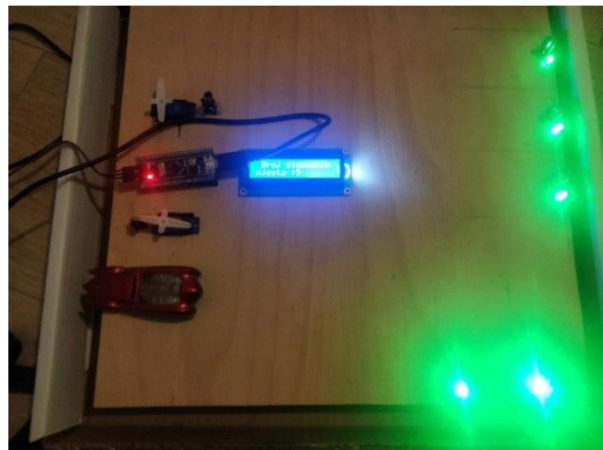
*Slika 4.2. Prikaz testiranja funkcionalnosti ulaska na parkiralište*
