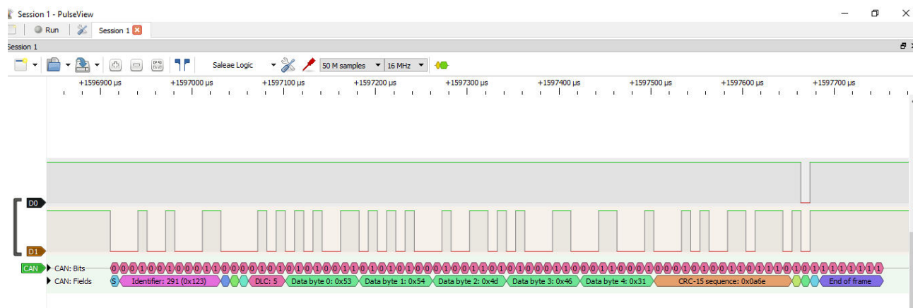
Slika 4.10. Izgled jednog CAN okvira
