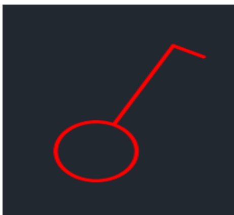
SI.4.11. Jednopolna sklopka
