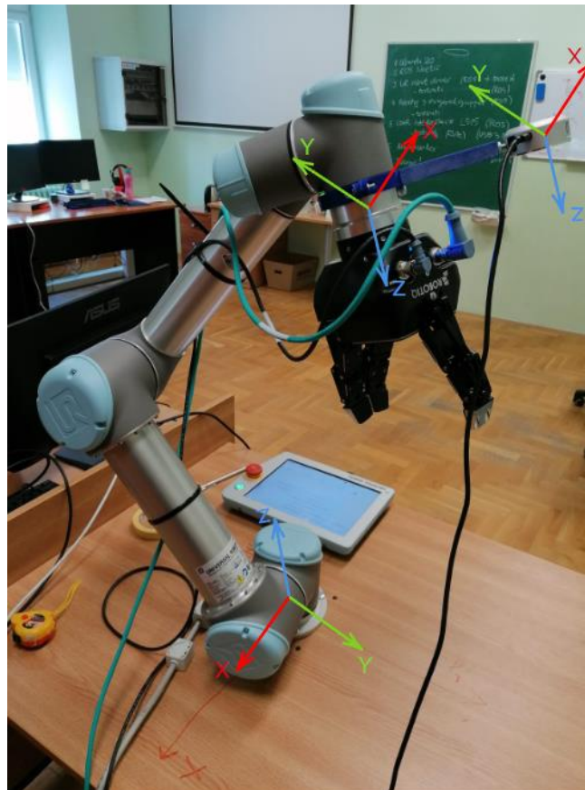
Slika 5.1 Eksperimentalni postav s označenim koordinatnim sustavima
