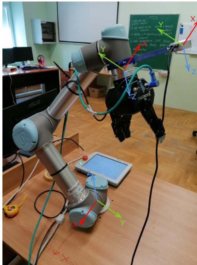
Slika 5.1 Eksperimentalni postav s označenim koordinatnim sustavima
