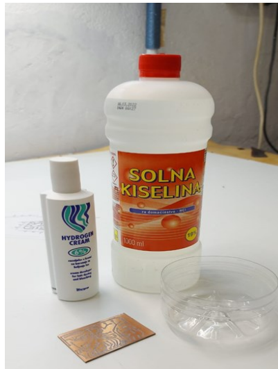
Slika 4.3 Solna kiselina, hidrogen, posuda i tiskana pločica
