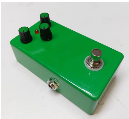
Slika 4.10 Aluminijsko kućište gitarske-efekt pedale
