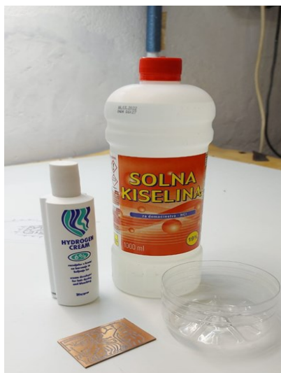
Slika 4.3 Solna kiselina, hidrogen, posuda i tiskana pločica
