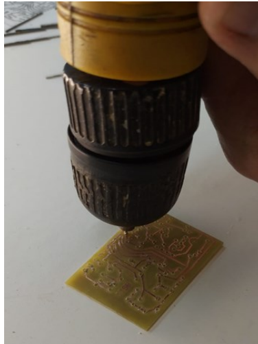
Slika 4.6 Bušenje rupa na predviđenim mjestima
