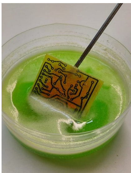
Slika 4.4 Kemijska reakcija na bakrenoj pločici
