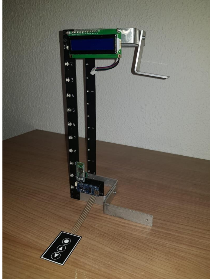
Slika 4.4. Nova izvedba makete s mikroupravljačkim sustavom
